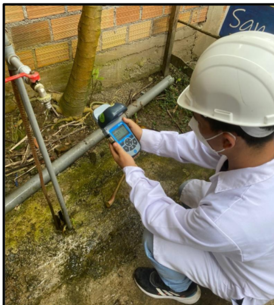
Fotografía N° 12. Muestreo de cloro residual en la última vivienda.
