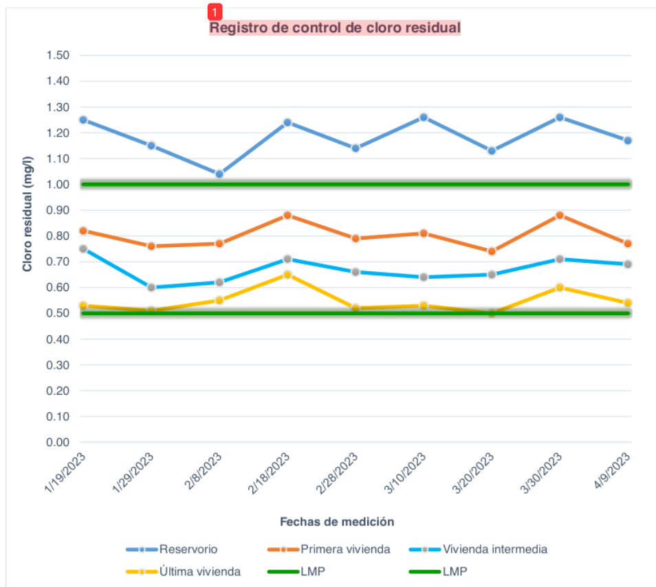
Figura 7. Registro de control de cloro residual
