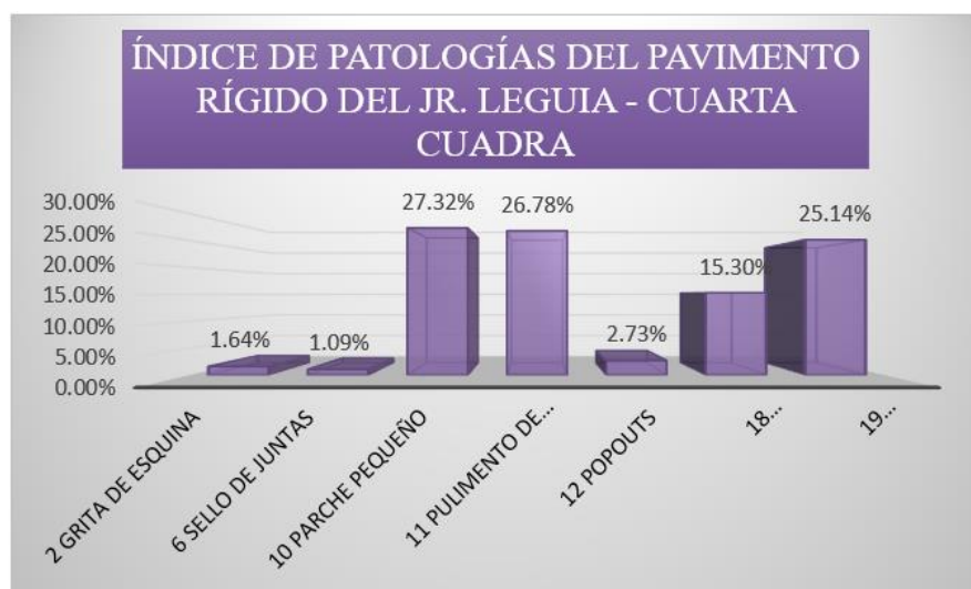
Figura N° 07: Índice de patologías del pavimento rígido del Jr. Leguía Cuarta cuadra
