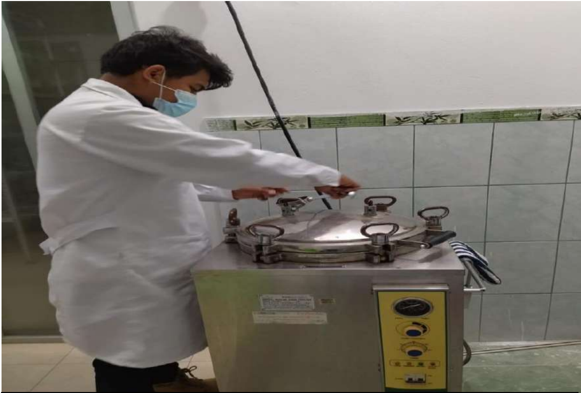
Fotografía 7. Autoclave para la esterilización de los medios de cultivo.
