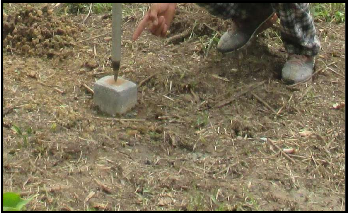
Punto de apoyo para el levantamiento topográfico
