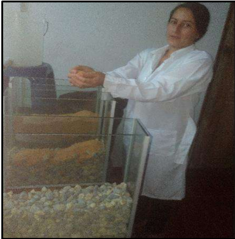
Imagen 5: Construcción del Lombrifiltro Fuente: (TESISTA MRC)
