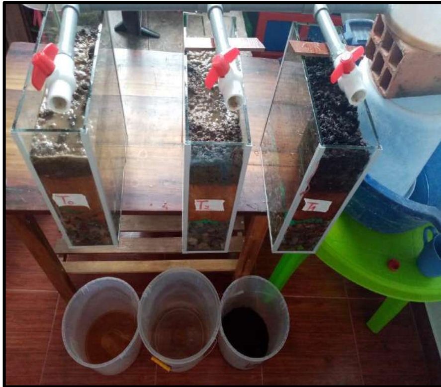
Imagen 7. Tratamiento del agua miel Fuente: (TESISTA MRC)
