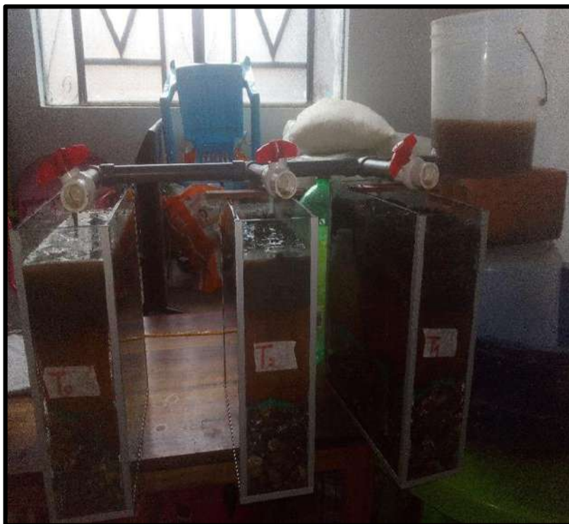
Imagen 6: Lombrifiltro. Fuente: (TESISTA MRC)
