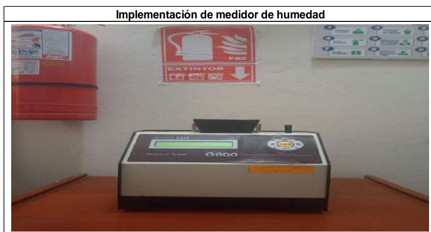
Figura 13 Implementación de medidor de humedad.
