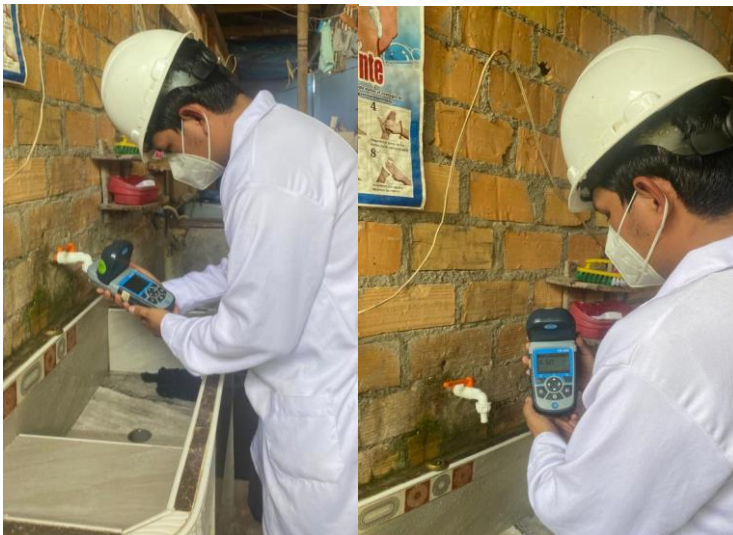
Figura 23 Monitoreo de cloro residual en la vivienda intermedia
