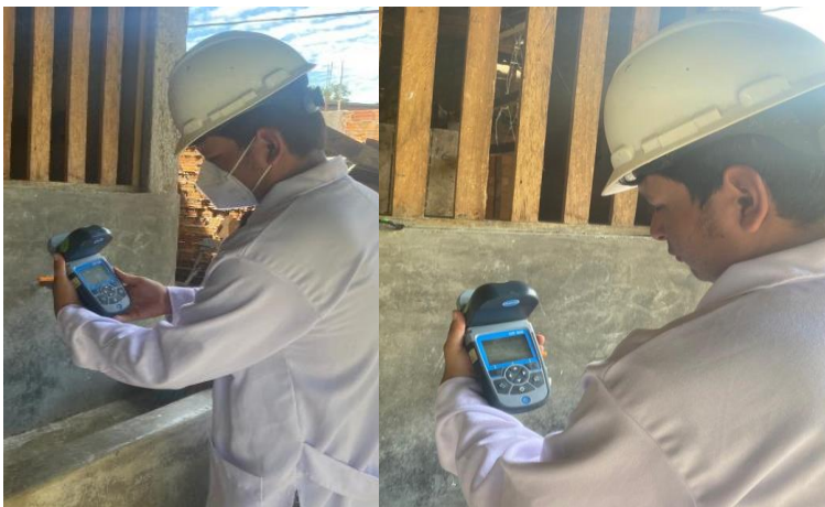
Figura 24 Monitoreo de cloro residual en la última vivienda
