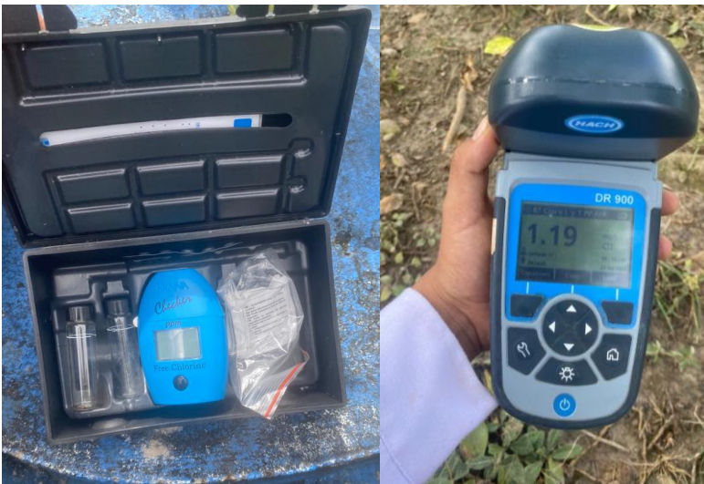
Figura 20 Equipos de monitoreo de cloro residual
