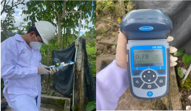
Figura 22 Monitoreo de cloro residual en la primera vivienda
