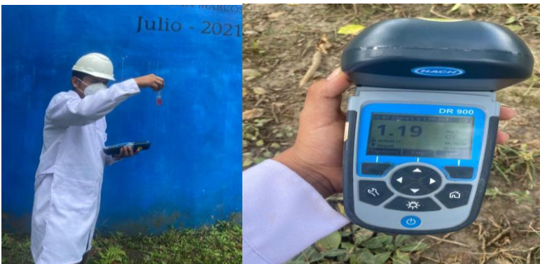
Figura 21 Monitoreo de cloro residual en el reservorio
