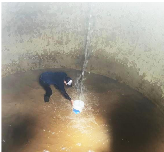
Figura 15 Medición de caudal de entrada al reservorio
