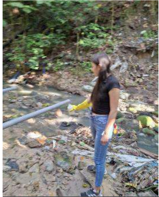
Fotografía 14. Toma de muestras de agua residual cruda y tratada en el afluente y efluente respectivamente, del sistema de tratamiento.
