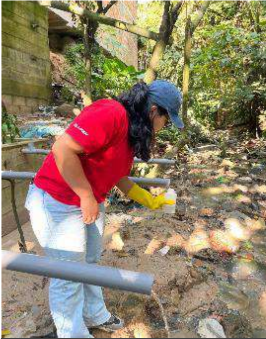
Fotografía 13. Toma de muestras de agua residual cruda y tratada en el afluente y efluente respectivamente, del sistema de tratamiento.
