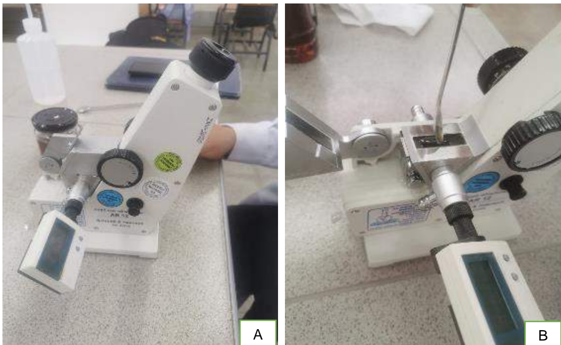
Figura 25 Análisis de sólidos solubles (°Brix). (a) acondicionamiento del refractómetro, (b) se añadió una gota de miel para ser analizada.
