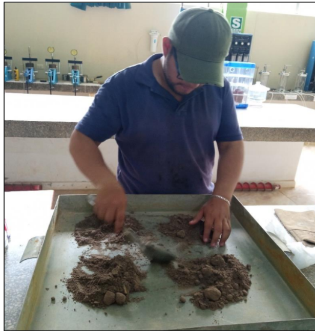
Foto N 3. Se observa el proceso de preparación de las Muestras para los ensayos de caracterización físicas de los suelos.
