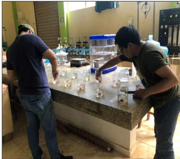
Foto N 6. Se aprecia el proceso de colocación de los cubos de 15 mm de aristas en los recipientes con agua para el ensayo de Crumb.
