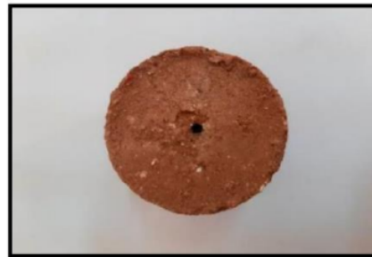
Lado que muestra la parte de la salida de la carga hidráulica
