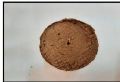
Lado que muestra la parte de la salida de la carga hidráulica
