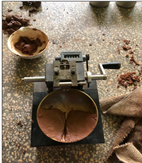
Foto N °5. Se observa el desarrollo del ensayo del límite líquido de la muestra en la copa de casagrande.
