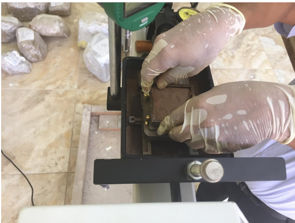
Colocación de la muestra en la máquina de compresión
