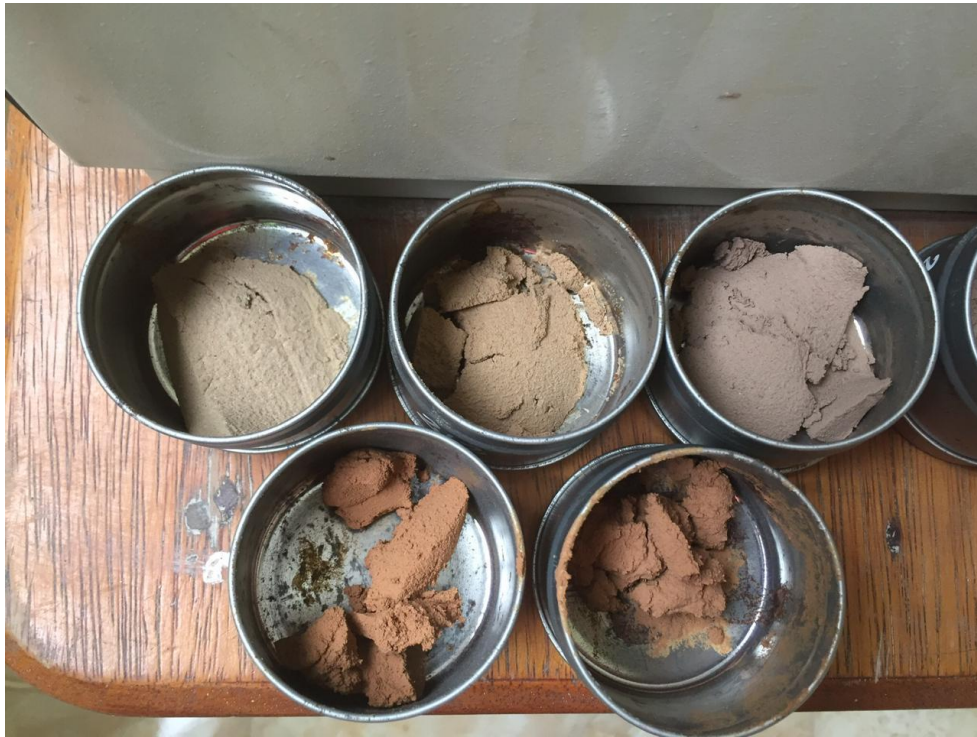
Muestra seca del límite líquido luego de ser sacada del horno
