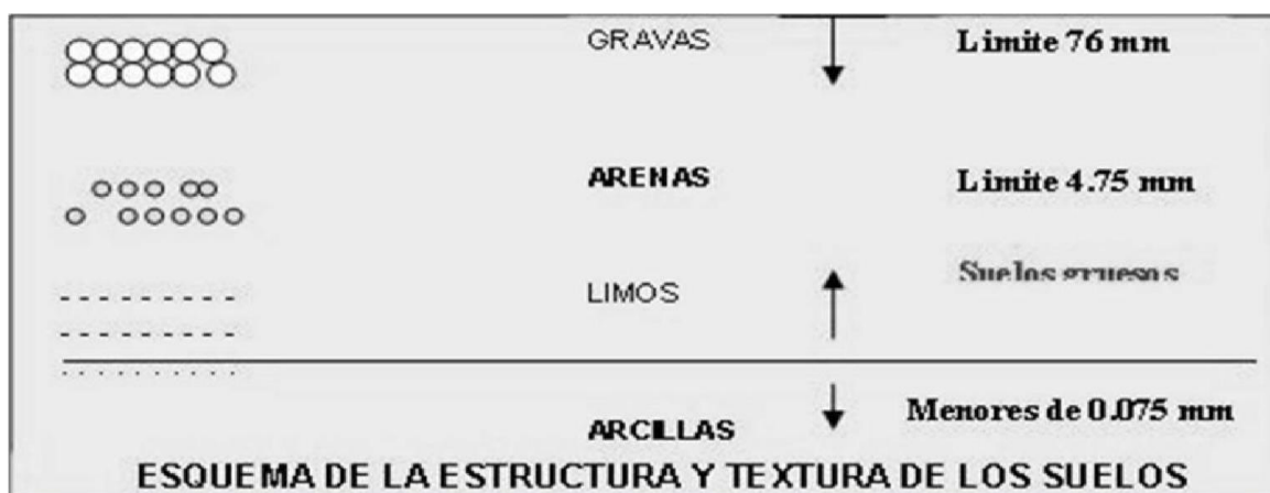
Figura 1. Esquema de la Estructura y Textura de los suelos. (Enrique Napoleón Martínez Quiroz, 2003).
