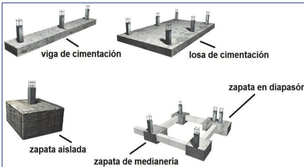
Figura 14. Algunos tipos de cimentaciones superficiales.(Imagen elaborada en: http://www.generadordeprecios.info/ )
