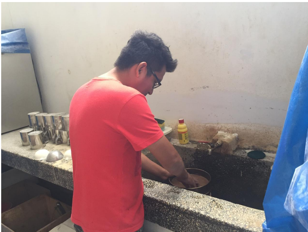
Lavando la muestra para proceder a la granulometría posteriormente
