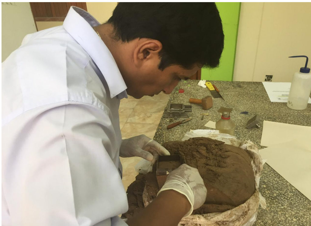
Sacando muestra para el ensayo de Corte Directo con el Técnico de Laboratorio, Ing. Robert Navarro.
