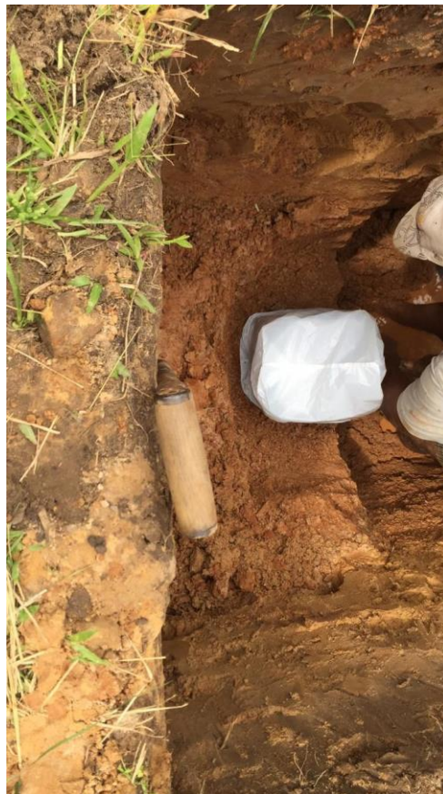
Extrayendo muestra para ensayo de corte directo
