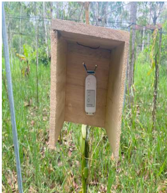
Fotografía 4. Registrador (Datalogger) instalado en sistemas de cultivo para el registro de temperatura y humedad relativa.
