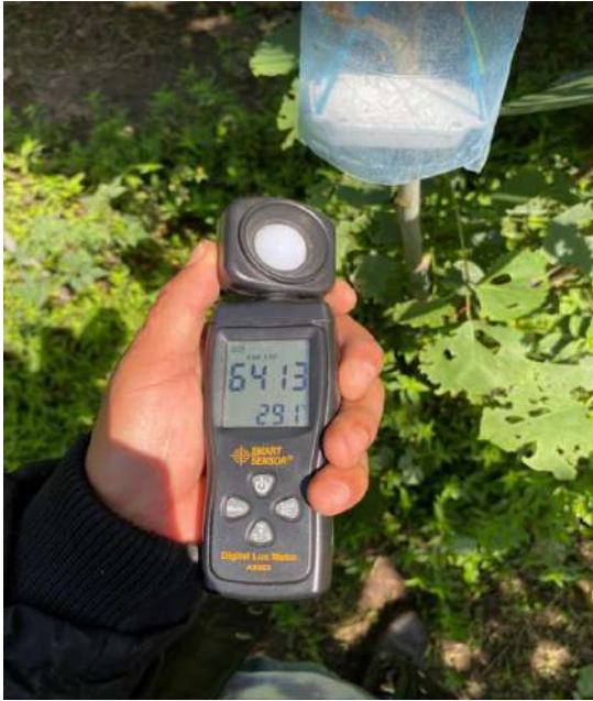
Fotografía 5. Registro de niveles de luminosidad con luxómetro.
