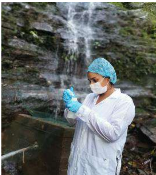
Fotografía 5. Preservación de muestras de metales totales con \text{HNO}_3 .
