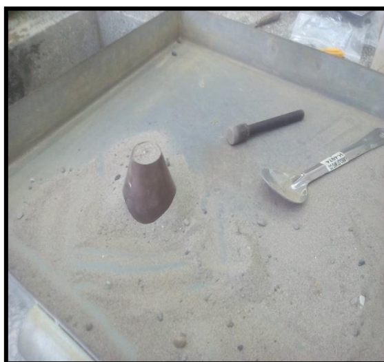
Foto 18 y 19: Prueba de humedad superficial del agregado fino
