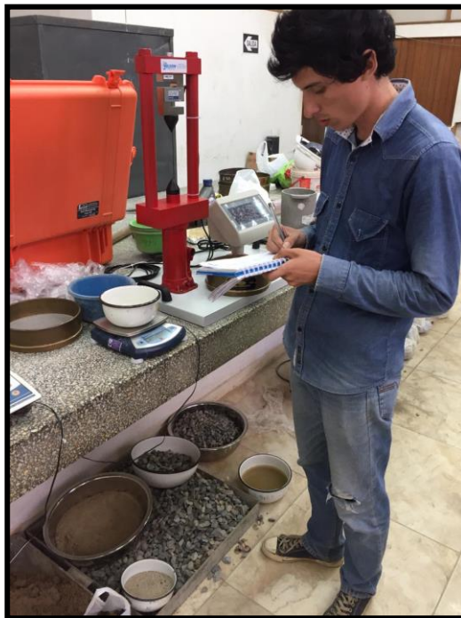
Foto 10: Pesaje de muestra retenidas en los tamices
