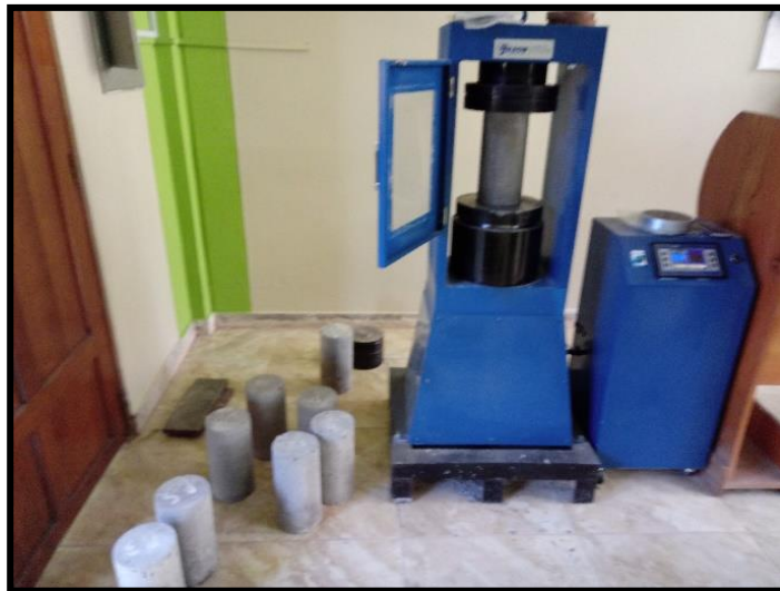
Foto 44: Ensayo de resistencia a la compresión hecha a los testigos de concreto
