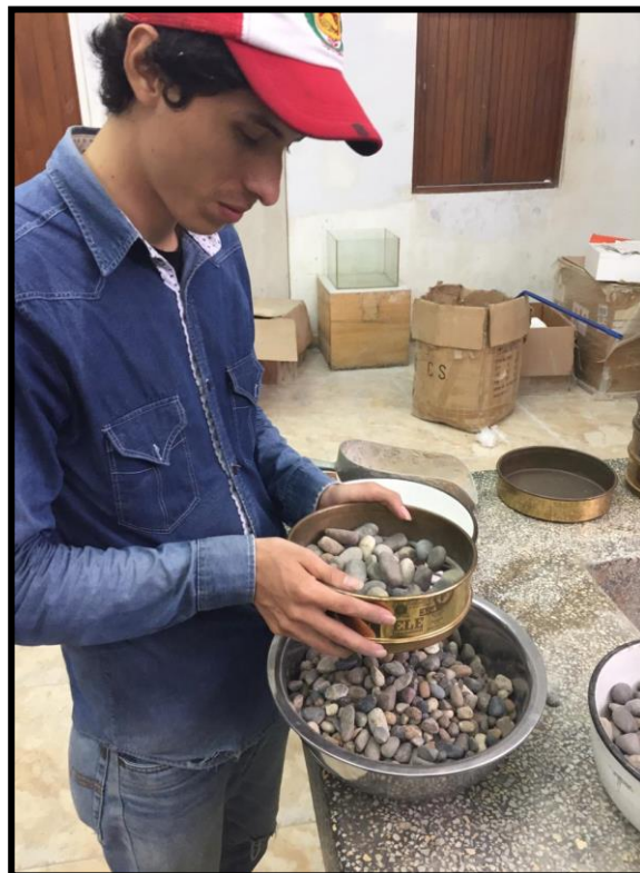
Foto 6: Tamizado del agregado grueso
