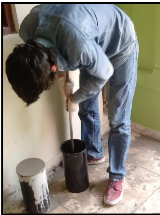
Foto 38: Uso de la varilla de acero para distribución uniforme de la mezcla en la probeta
