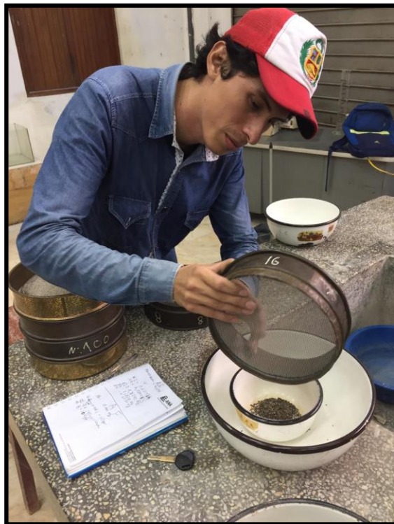
Foto 8: Material retenido en el tamiz de agregado fino
