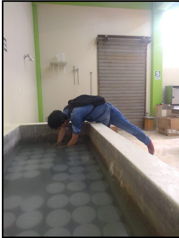
Foto 43: Almacenamiento de los testigos de concreto en la piscina de agua
