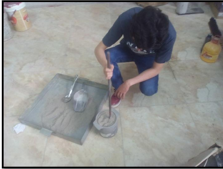
Foto 13: Ensayo de Peso Unitario
