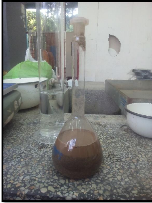
Foto 22: Picnómetro con muestra de agregado fino con adición de agua
