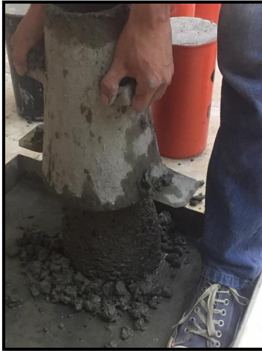
Foto 35: Ensayo cono de Abrams
