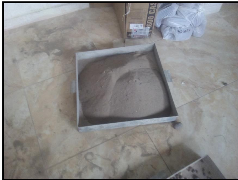
Foto 2: Selección de muestra de agregado fino
