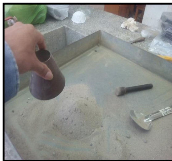
Foto 18 y 19: Prueba de humedad superficial del agregado fino
