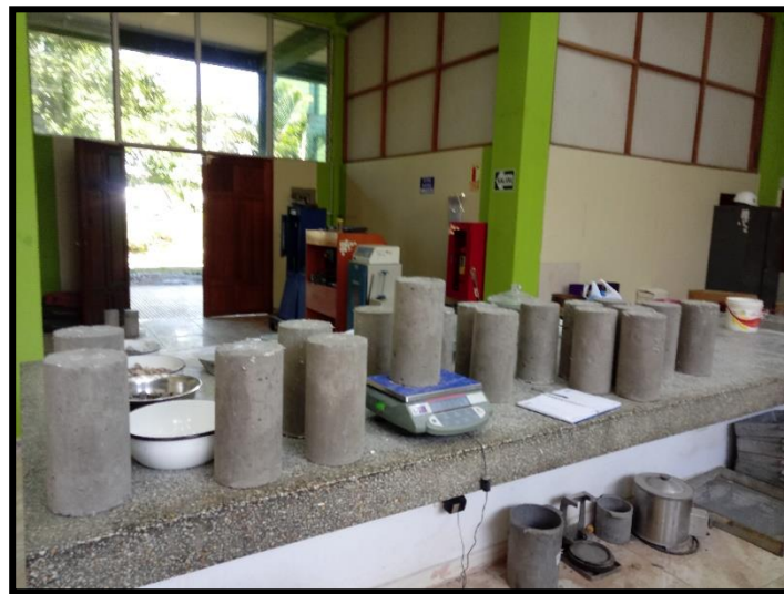
Foto 42: Pesaje de los testigos de concreto
