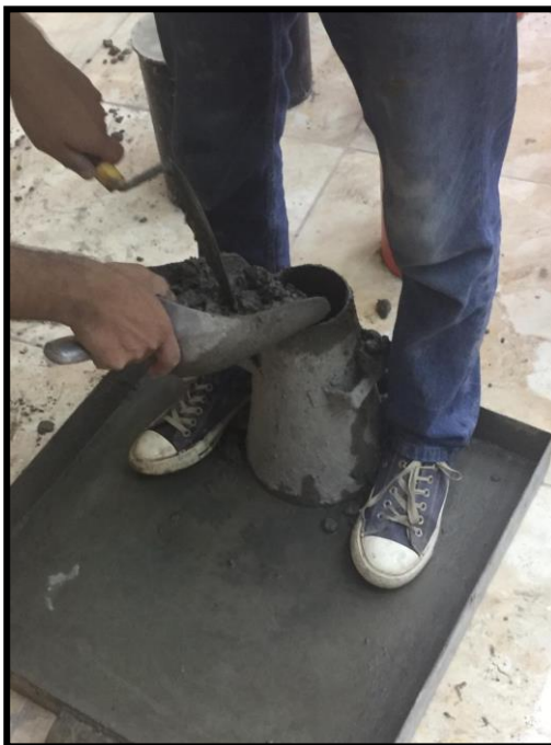
Foto 34: Colocación de muestra de concreto en el cono de Abrams
