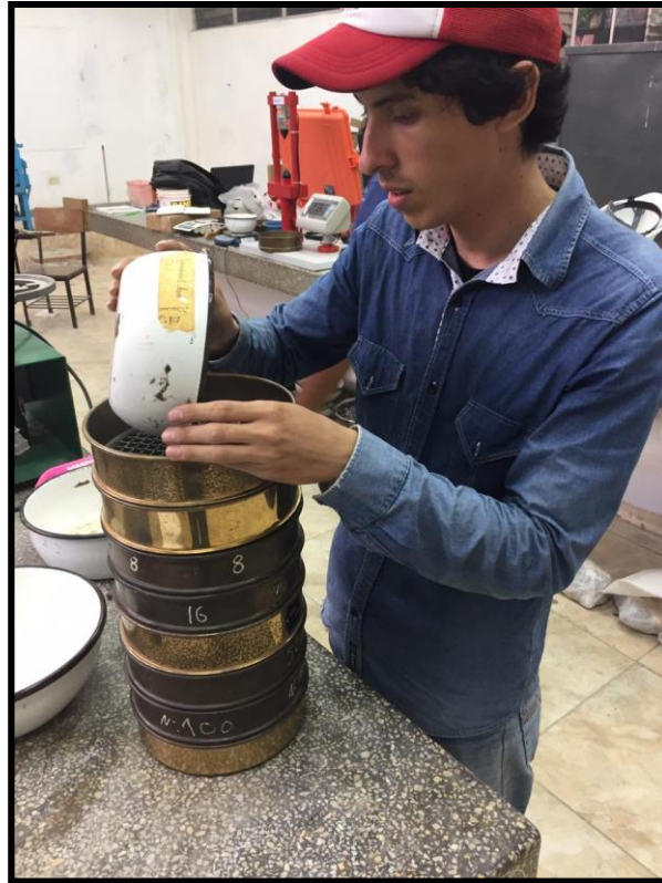
Foto 5: Análisis granulométrico de los agregados
