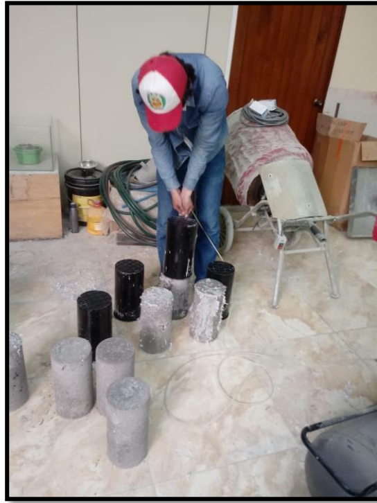
Foto 41: Desmoldado de las probetas
