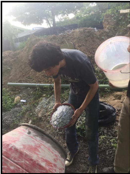
Foto 28, 29, 30 y 31: Colocación de materiales en el trompo para la elaboración de concreto patrón y con adición de PET
