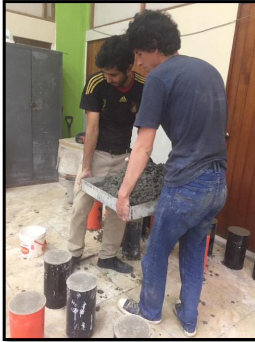
Foto 33: Colocación de muestra de concreto para elaboración de las probetas
