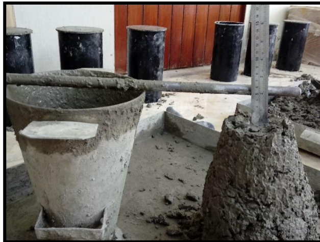
Foto 36: Medida de asentamiento de la mezcla de concreto
