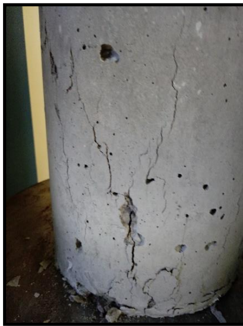
Foto 51: Falla de rotura del testigo de concreto con adición de 15% de PET
