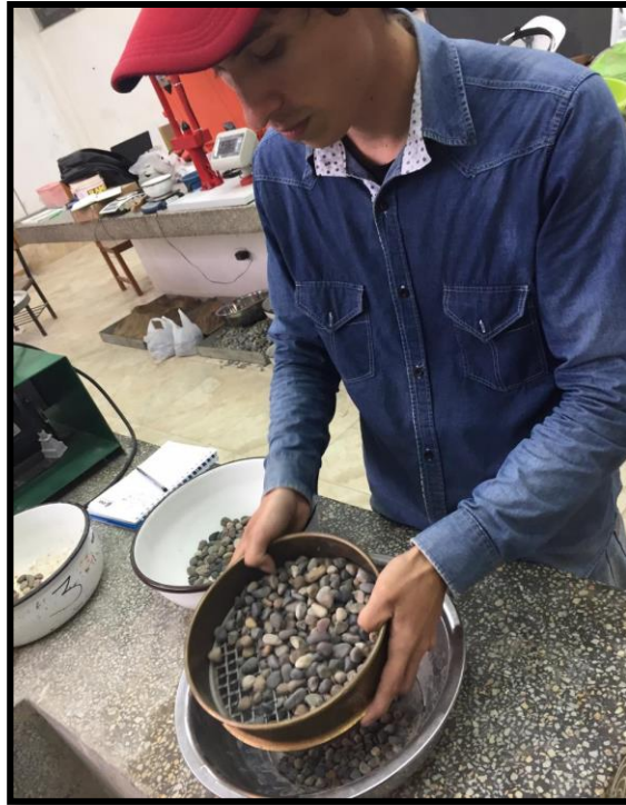
Foto 7: Retenido muestra de agregado grueso
