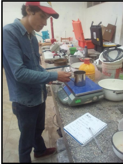
Foto 15: Peso de muestra húmeda
