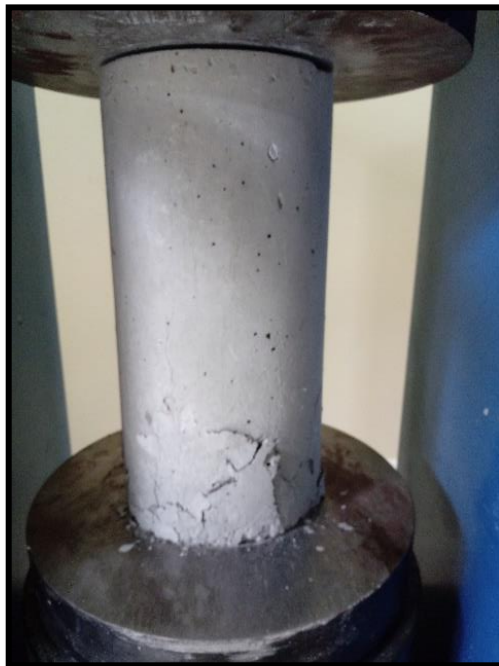
Foto 49: Rotura de testigo de concreto con adición de 5% de PET
