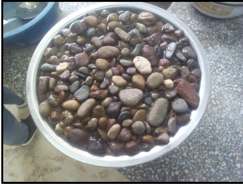
Foto 3: Muestra Saturada de agregado grueso
