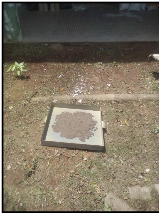
Foto 17: Muestra de agregado fino secada al sol
