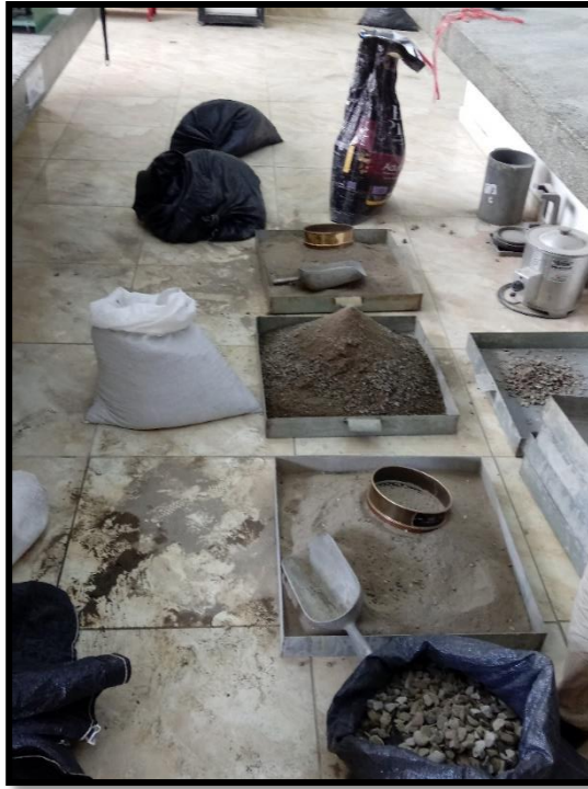
Foto 26: Materiales para la elaboración de probetas de concreto
