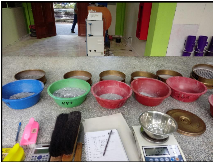
Foto 25: Análisis granulométrico de plástico triturado PET
