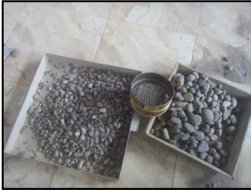
Foto 1: Selección de muestra de agregado grueso
