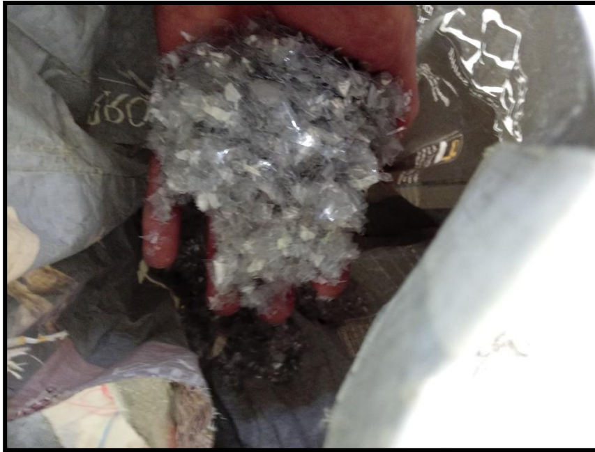
Foto 24: Muestra representativa de plástico triturado PET
