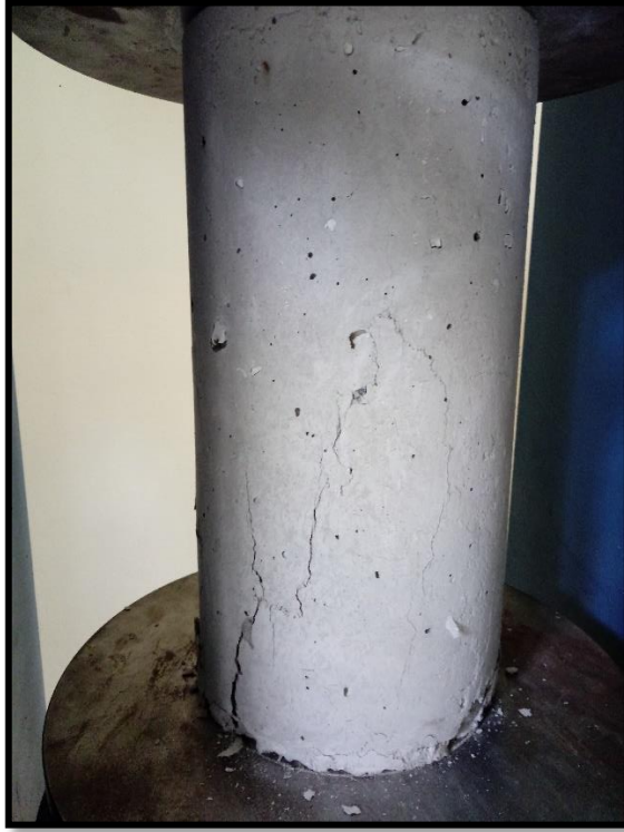
Foto 48: Falla típica del testigo con adición de plástico PET
