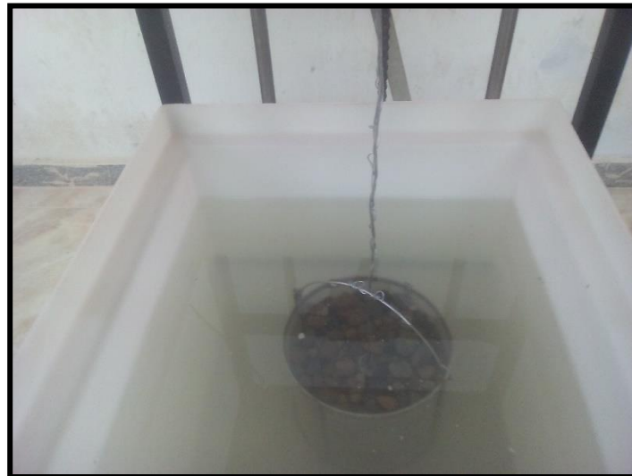
Foto 12: Canastilla sumergida en agua con muestra de agregado grueso
