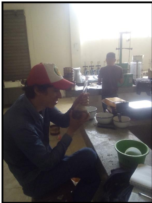
Foto 21: Agitación del picnómetro para ensayo de peso específico del agregado fino
