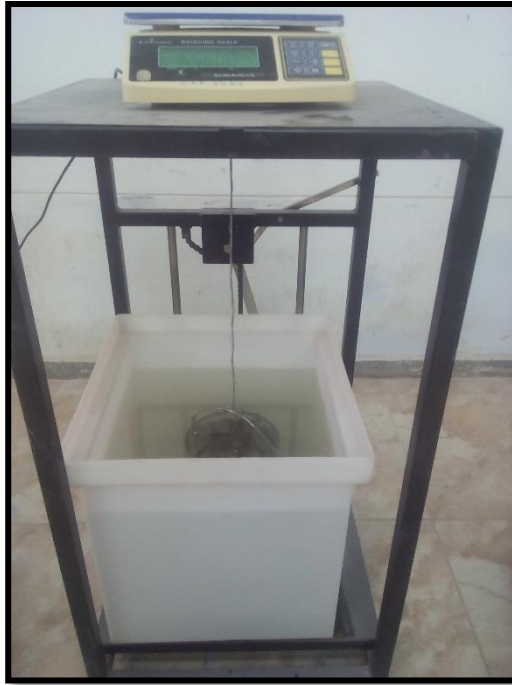
Foto 11: Ensayo de Peso Específico y absorción del agregado grueso
