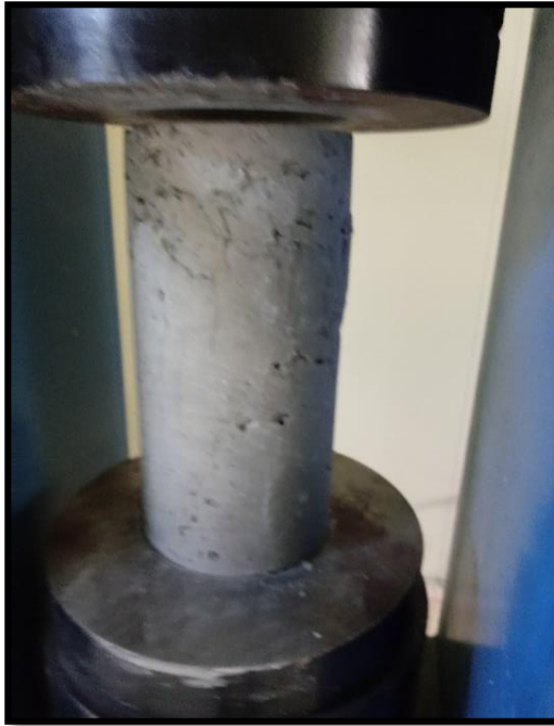
Foto 50: Rotura de testigo de concreto con adición de 10% de PET
