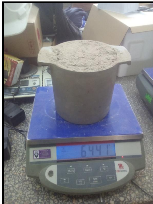
Foto 14: Pesaje del molde de ensayo de peso unitario
