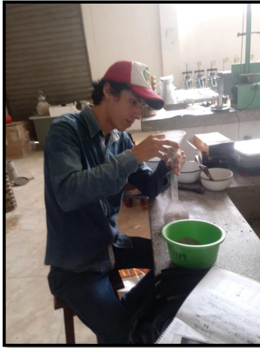
Foto 20: Colocación de muestra de agregado fino en el picnómetro
