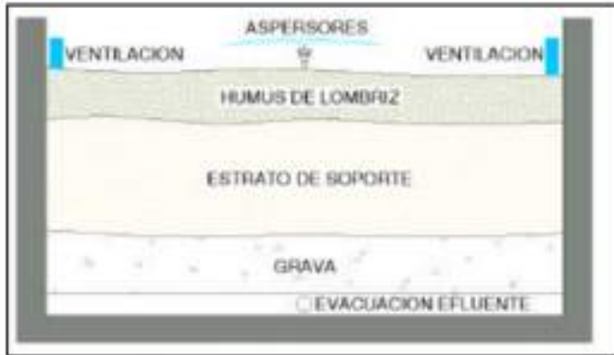
Imagen 3: Descripción de las capas de un Lombrifiltro. Fuente: A.V.F. INGENIERÍA AMBIENTAL, 2003.
