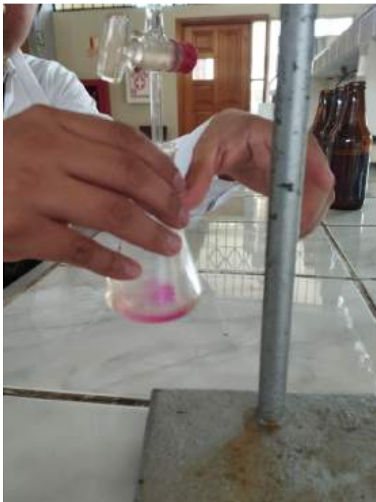
Anexo 8. Titulación de las muestras de cerveza para determinar la acidez.
