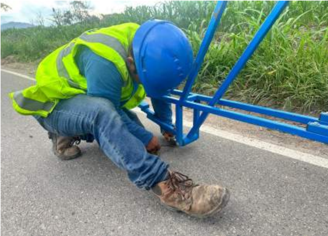
Foto 20: Calibración de rugosímetro de Merlín.
