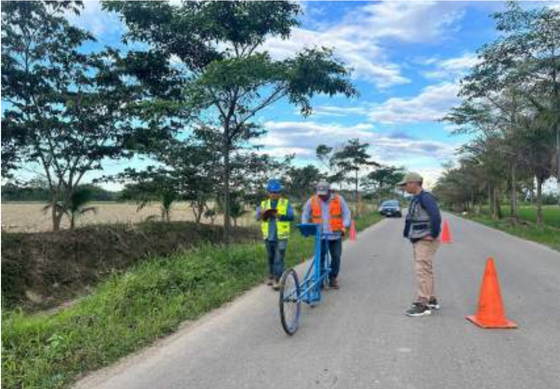
Foto 19: Ejecución del método de Rugosímetro de Merlín.
