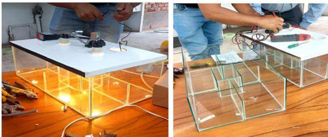
Fotografía 1. Proceso de construcción de invernars e instalación de termostato
