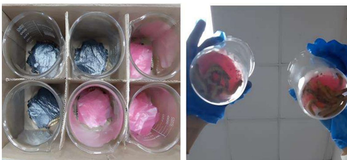
Fotografía 3. Proceso de biodegradación de Polietileno de baja densidad
