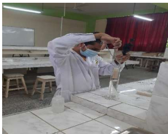
Foto 35: Determinación volumen inmersión en agua
