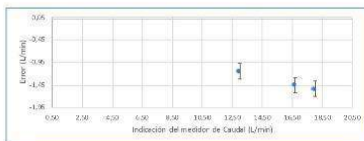
Figura 1.- Curva de calibración del medidor de caudal, el fluido de trabajo fue aire atmosférico.
