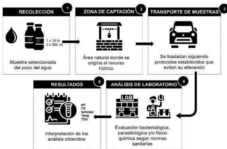
Figura 4 Procedimiento para análisis en laboratorio
