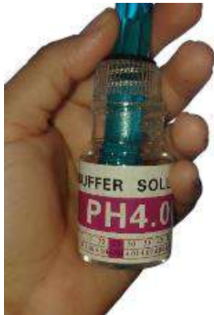
Figura 20 Calibración con solución pH 4.00
