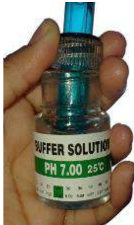
Figura 21 Calibración con solución pH 7.00
