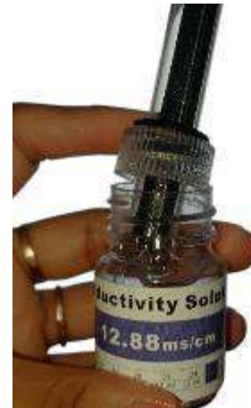
Figura 22 Calibración con solución de conductividad 12.88
