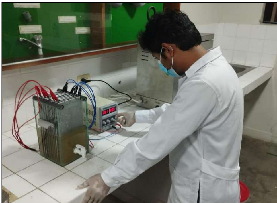
Fotografía 2 Puesta en marcha del reactor para el tratamiento por electrocoagulación.
