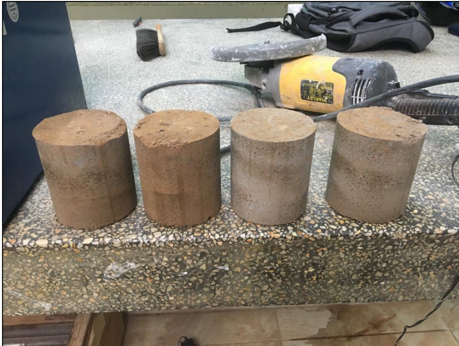
Foto 31: Especímenes con adición de cemento de 6%, 8%, 10% y 12%.
