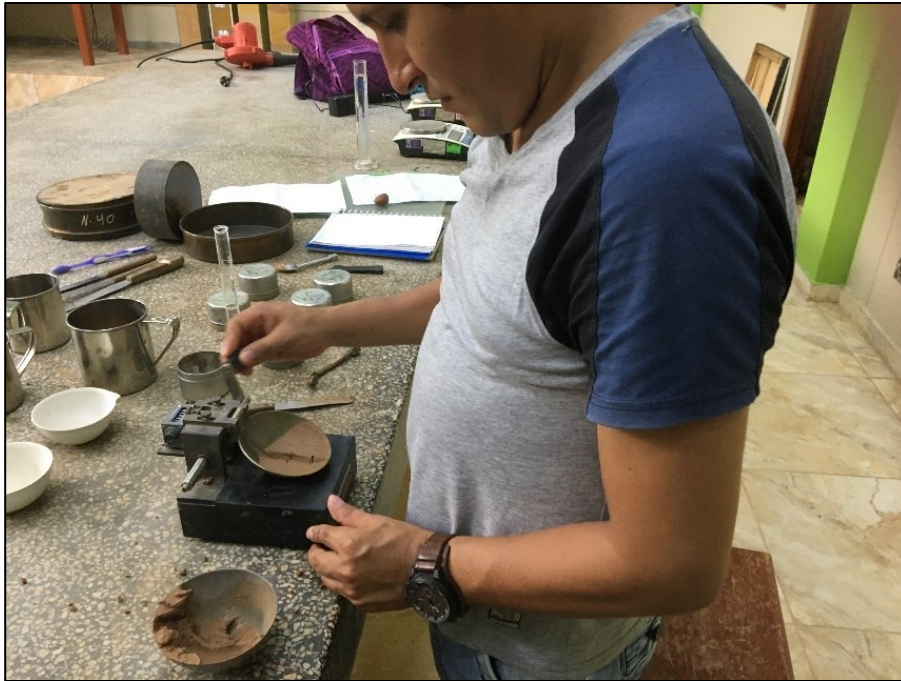
Foto 13: Ensayo del límite líquido
