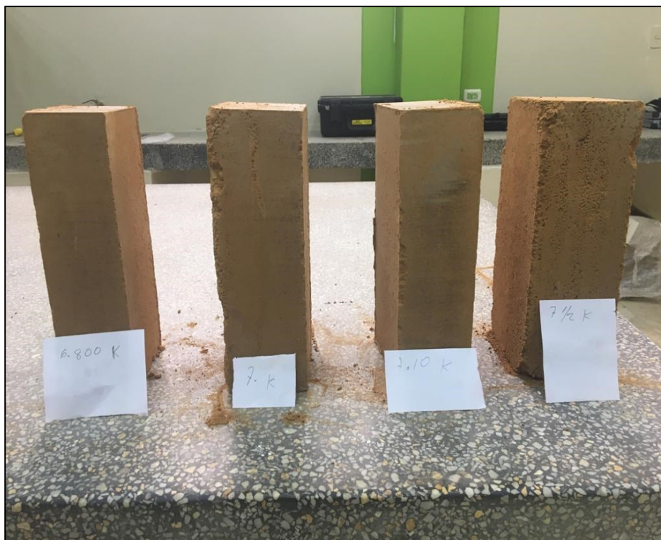
Foto 48: Resultado de las proporciones de suelo cemento para llegar a las dimensiones estándares.
