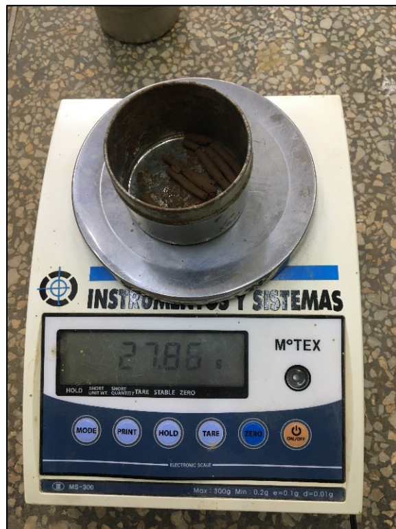
Foto 16: Ensayo para determinar el índice plástico
