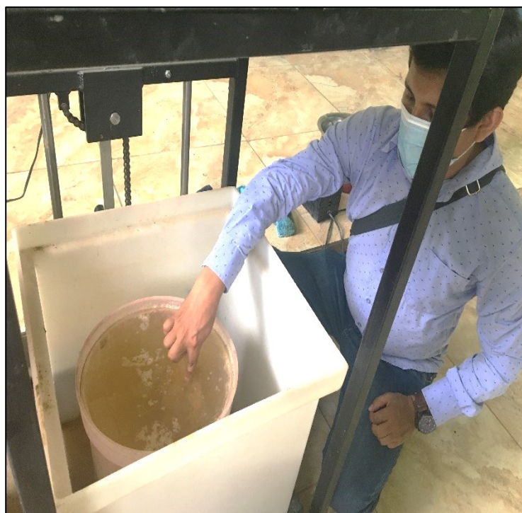
Figura 35: Se muestra los BTC, sumergidos en agua por 24 horas
