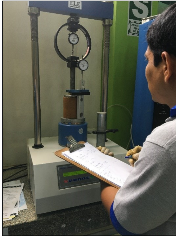
Foto 37: Registro de datos de rotura a compresión.
