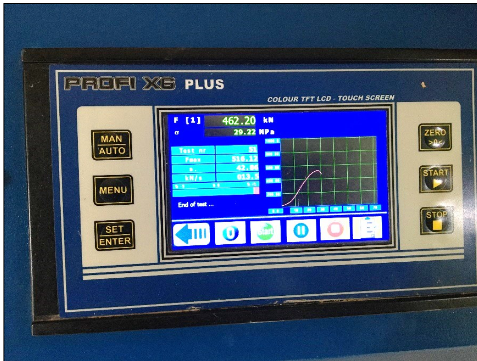
Foto 59: Resultado de la rotura del espécimen fabricado con el 10% de cemento fabricado en las 7:00am – 10:00am.
