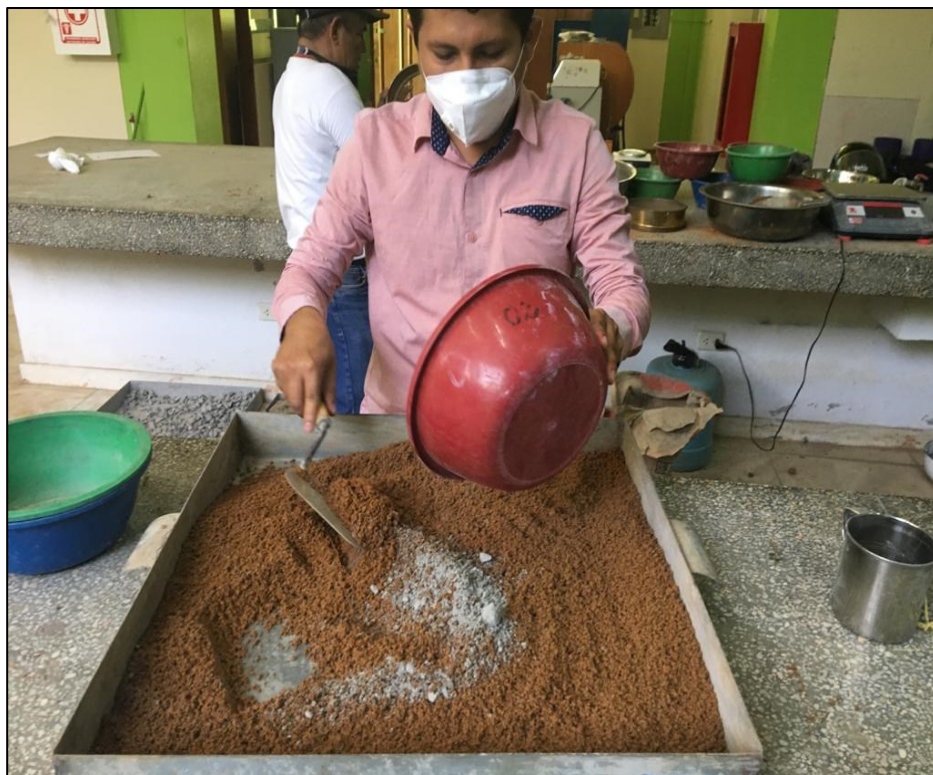
Foto 42: Mezclado del suelo con cemento.
