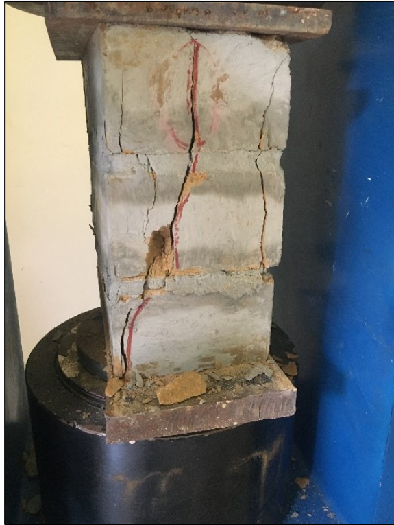
Foto 78: Se muestra la falla de las pilas
