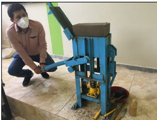
Figura 32: Extracción de la muestra de la maquina Cinva Ram – Modificada.
