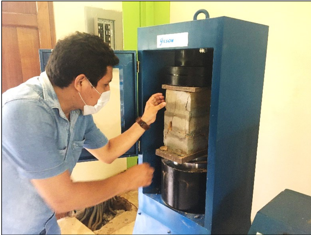
Foto 76: Se muestra las fallas de la pila
