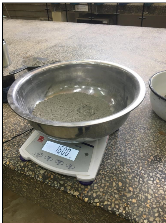
Foto 26: Peso del cemento.
