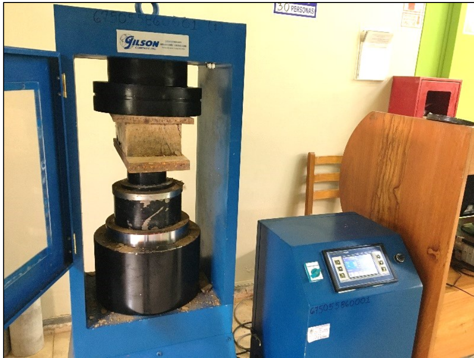
Foto 63: Resultado de la rotura del espécimen fabricado con el 10% de cemento fabricado en las 10:00am – 1:00pm
