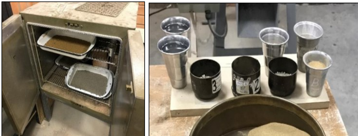
Figura 11: Ensayo para contenido de humedad de suelo. (Fuente: Pablo J. Mejía P., 2017)
