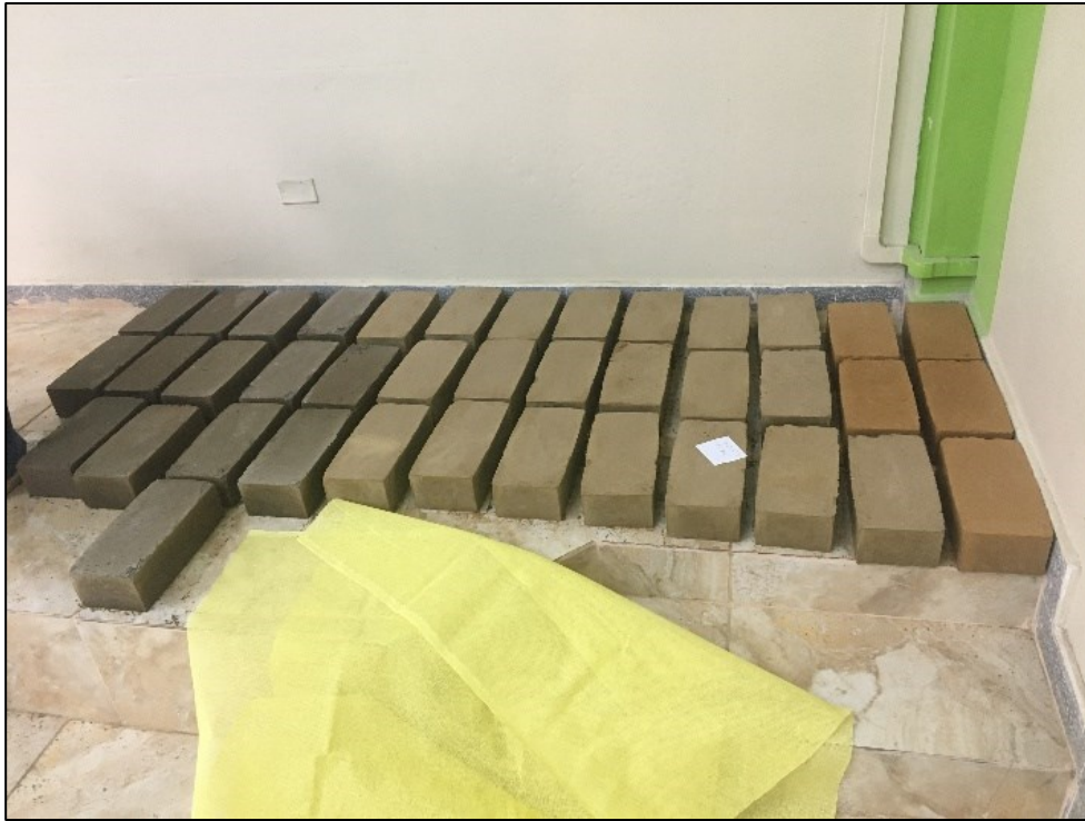
Foto 51: Inspección para el curado.
