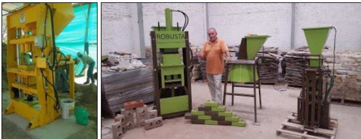
Figura 3: Prensas industriales para fabricación de BTC. (Fuente: Qingdao, 2017).
