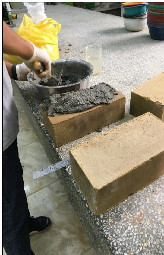
Foto 69: Fabricación de pilas de tres bloques.
