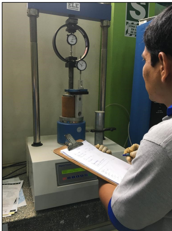
Figura 18: Equipo manual para la compresión no confinada (Fuente: Propia)
