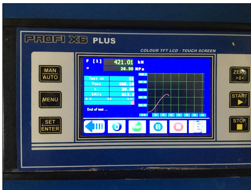
Foto 62: Resultado de la rotura del espécimen fabricado con el 10% de cemento fabricado en las 10:00am – 1:00pm
