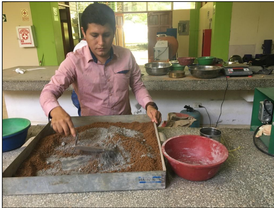
Foto 43: Mezclado del suelo con cemento.
