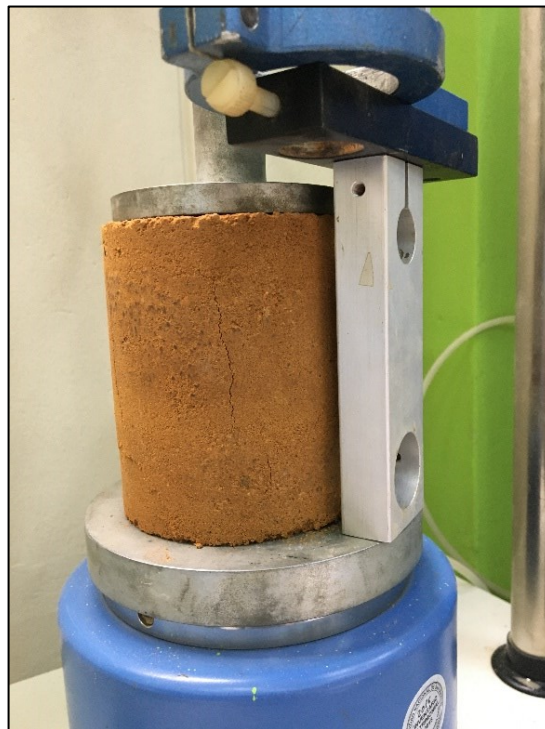
Foto 38: Verificación de las fallas que presenta el espécimen
