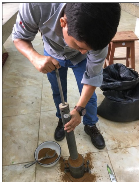
Figura 17: Ensayo proctor modificado (Fuente: Propia)
