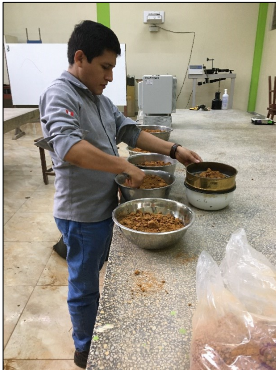
Foto 17: Pesando la muestra por la malla N°04
