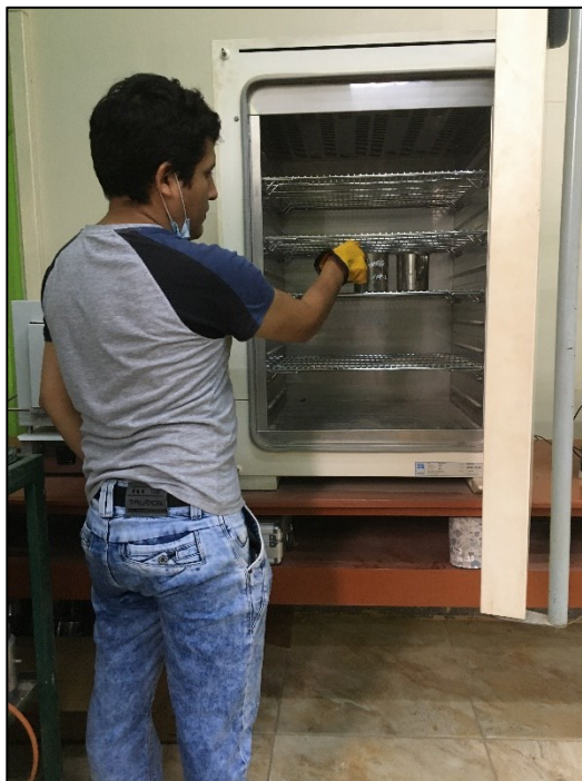
Foto 20: Colocación de los especímenes en el horno.
