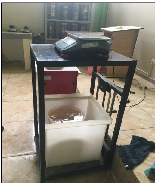
Figura 37: Las muestras sumergidas por 24 horas para determinar su densidad
