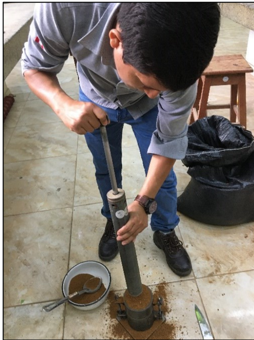
Foto 19: Ensayo de Proctor normal
