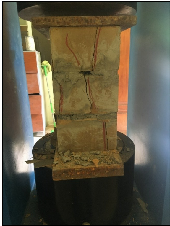
Foto 79: Se muestra la falla de las pilas parte posterior
