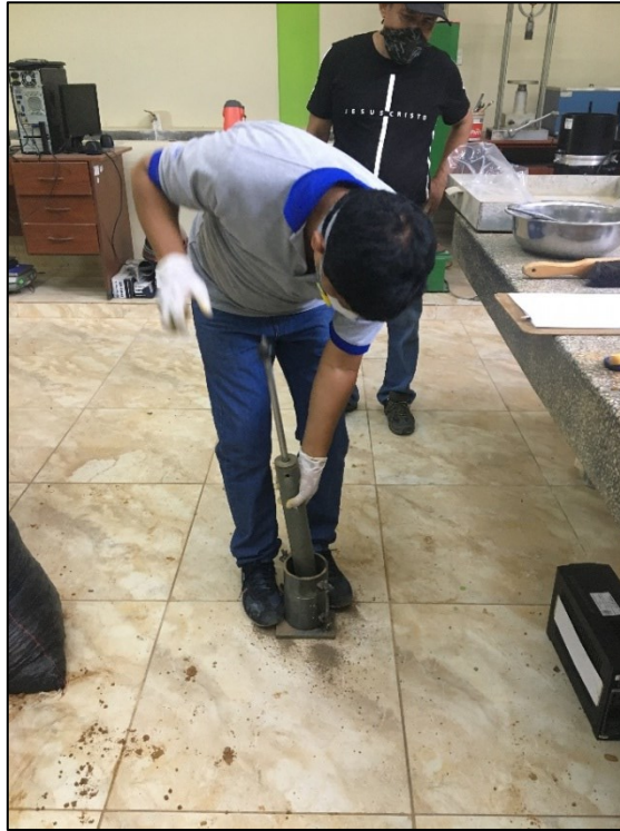
Foto 27: Ensayo de Proctor suelo-cemento.
