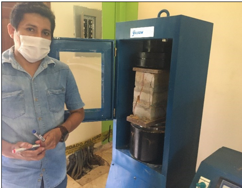
Foto 77: Se muestra las fallas en sentido vertical
