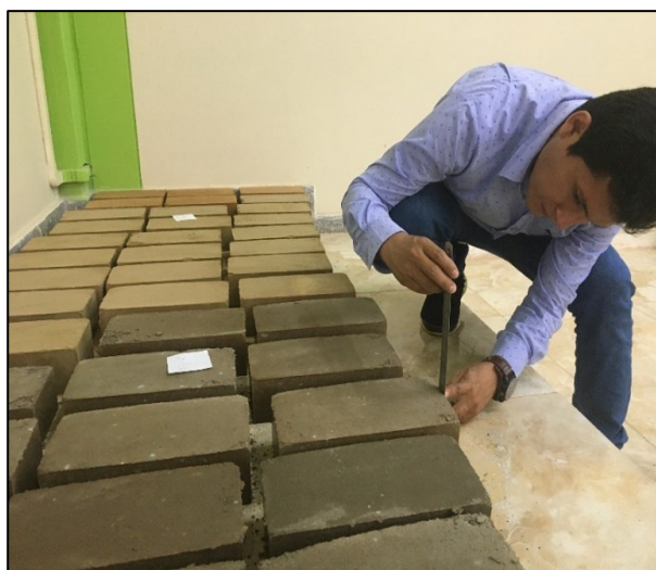
Figura 38: verificando las medidas de los bloques de tierra comprimida
