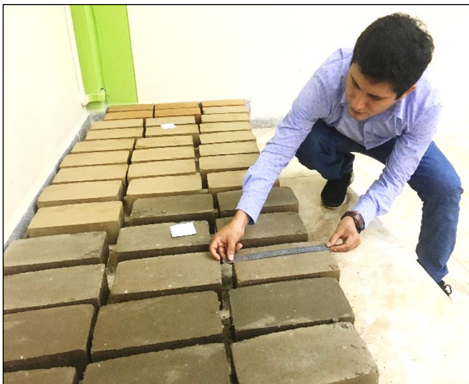
Foto 67: Verificando las dimensiones del BTC.
