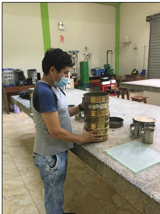
Foto 10: Ensayo de granulometría
