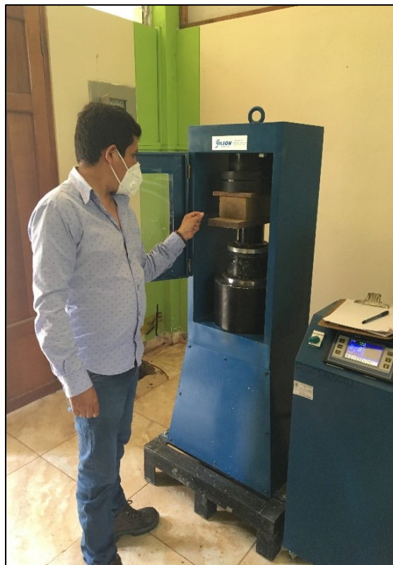
Foto 54: Se centra el BTC para medir la fuerza a compresión.
