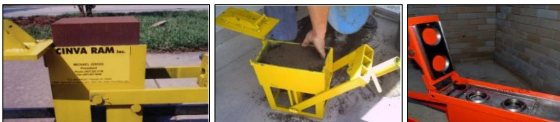
Figura 2: Máquina CINVA RAM con molde macizo o molde tipo LEGO. (Fuente: Papercrete, 2010)
