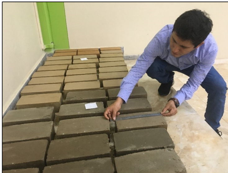
Figura 36: Verificando el alabeo en los bordes del BTC
