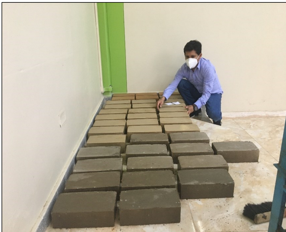
Foto 52: Inspección para el curado.
