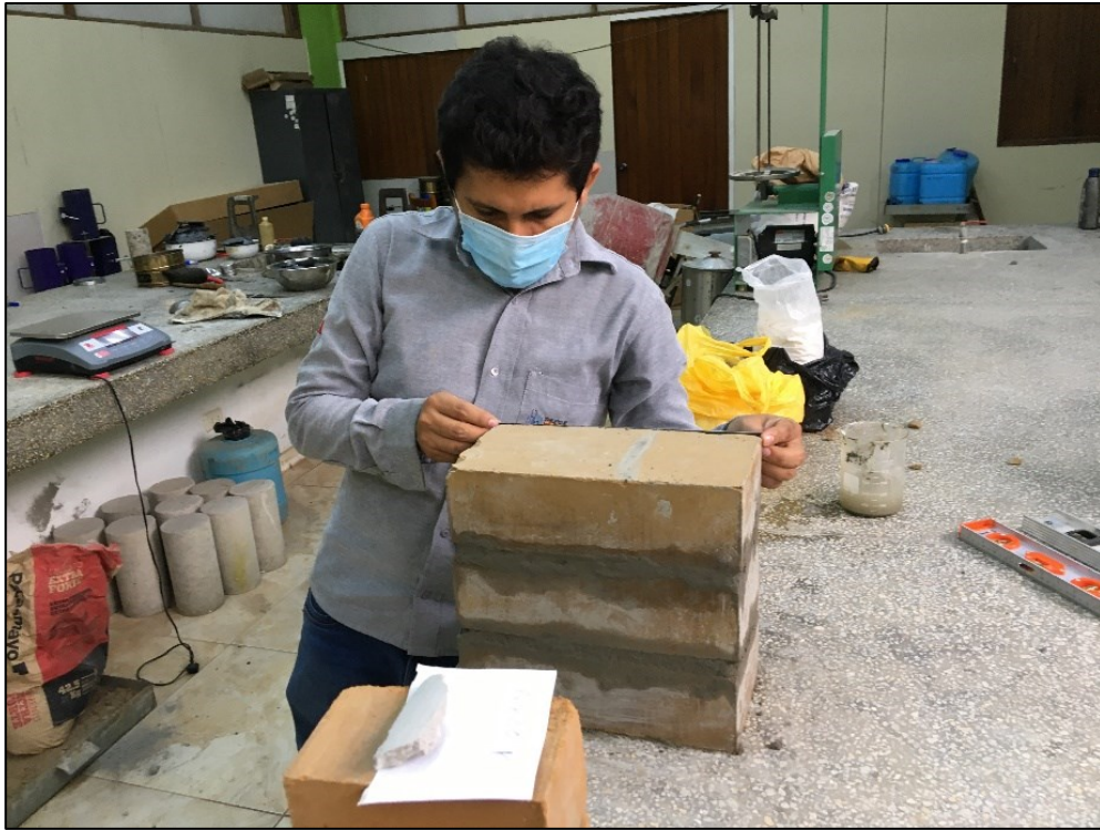
Foto 72: Medidas de las pilas.
