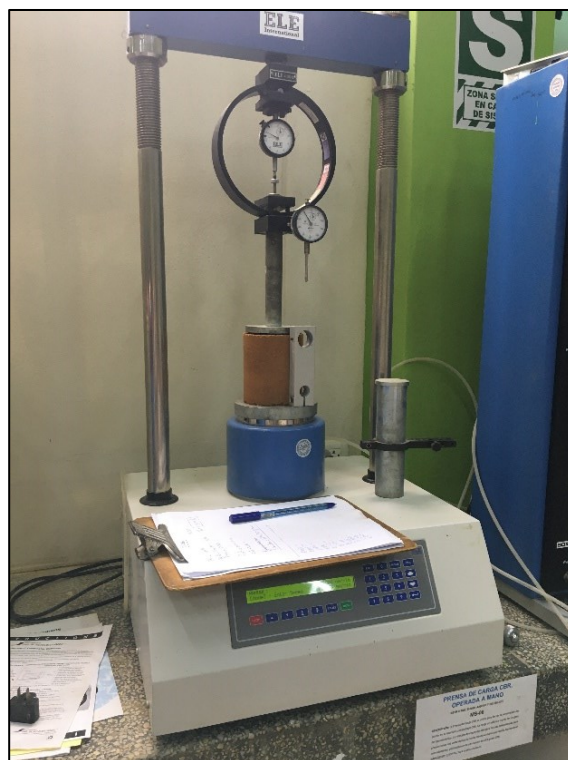
Foto 36: Compresión no confinada de los especímenes
