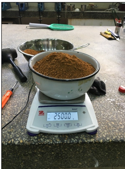
Foto 18. Pesando el suelo para el ensayo Proctor
