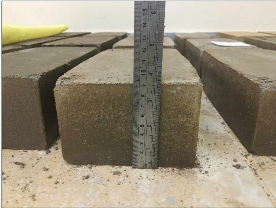
Foto 68: Medición de los bloques de tierra comprimida
