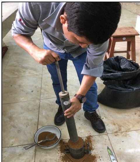
Figura 31: Compactado en capas de 3 y cada capa 25 golpes
