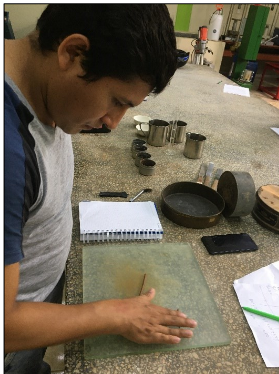
Foto 14: Ensayo de límite plástico
