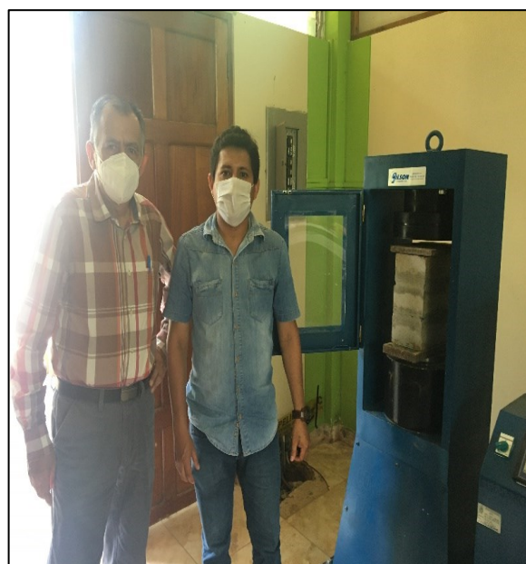
Figura 40: se procedió a romper la pila de BTC, verificado por el Asesor
