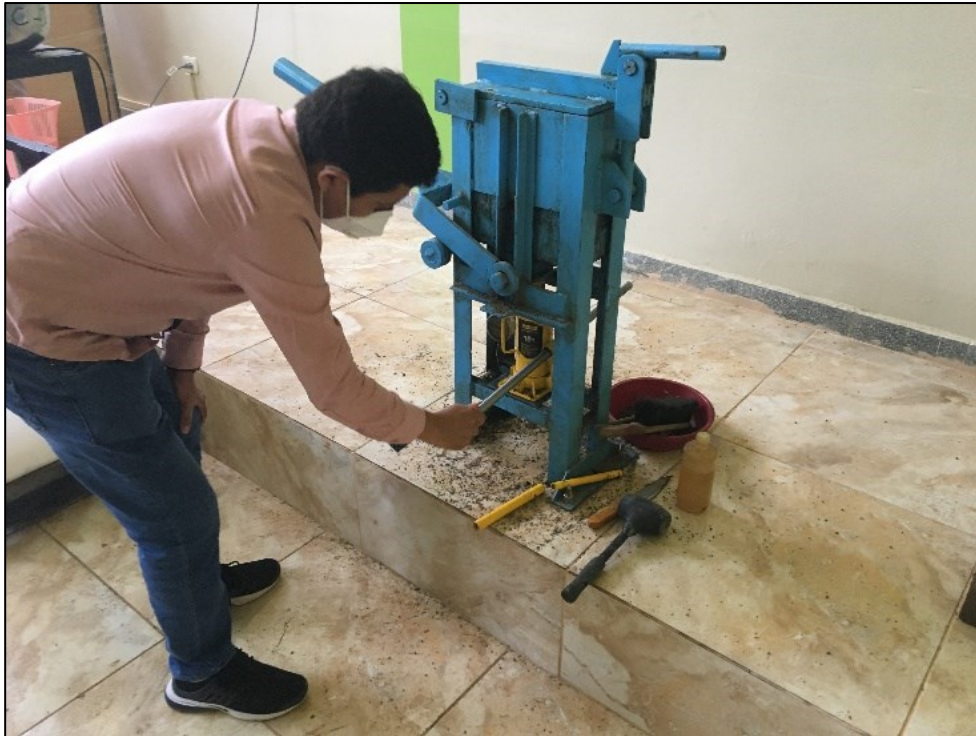
Foto 45: Compactando el bloque a razón de 7000 Psi.
