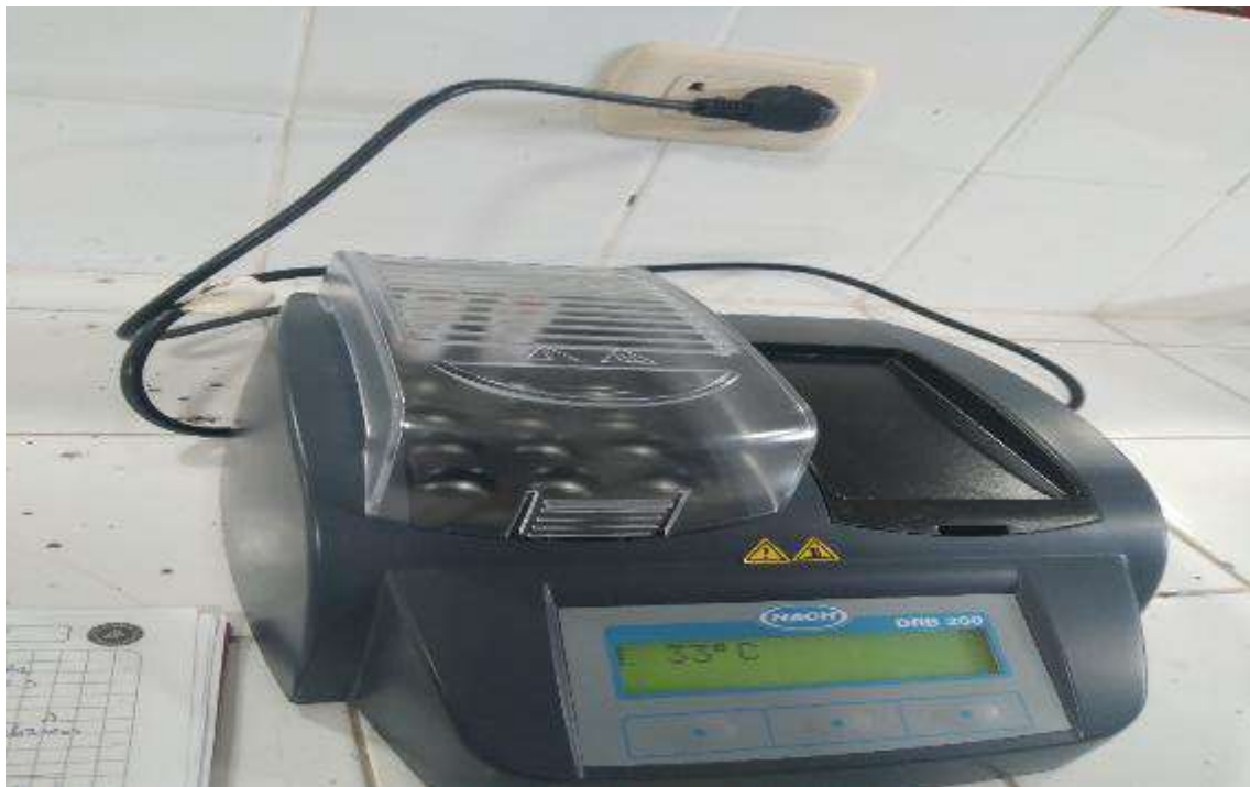
Fotografía 10. Análisis de las concentraciones de DBO 5 y DQO del agua residual cruda y tratada del camal municipal de Moyobamba.
