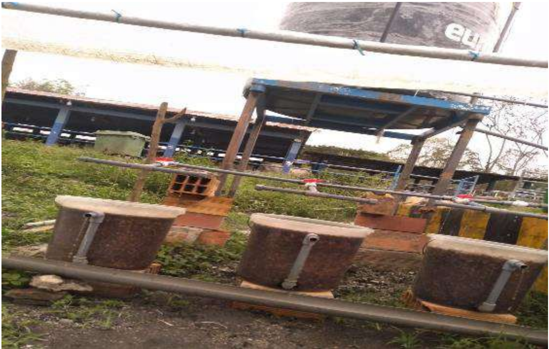
Fotografía 7. Funcionamiento del sistema de filtro de piedra pómez y puntos de muestreo donde se recolectaron las muestras postratamiento.
