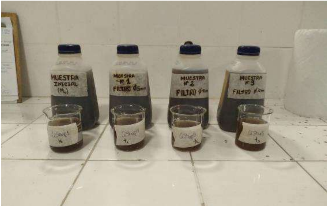
Fotografía 9. preparación de muestras de agua residual cruda y tratada para su análisis de laboratorio.
