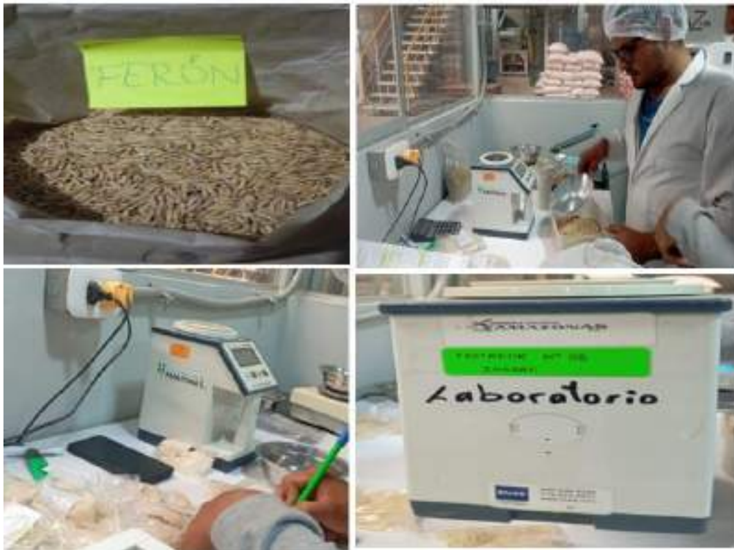
Figura 1 Determinación del %humedad (Grain Moisture Tester PM-450).
