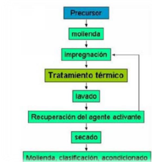
Figura 2: Diagrama de la activación química
