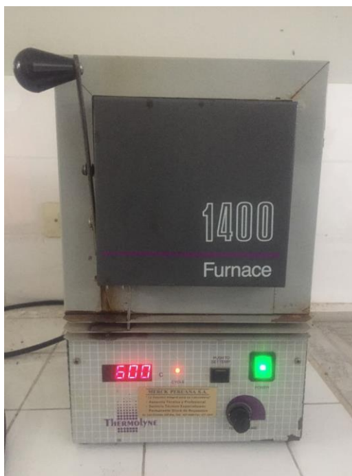
Calcinación a 600 °C del carbón
