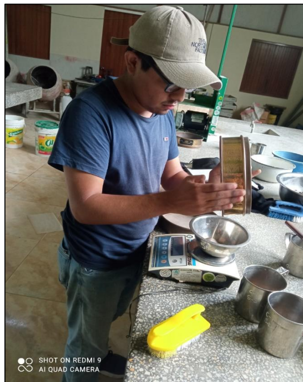
Foto N 4. Se observa el proceso de pesado de los suelos retenidas en los diferentes tamices que se requiere para el ensayo granulométrico.
