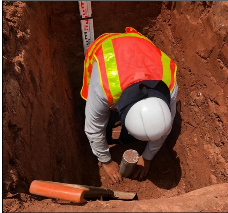
Foto N °1. Se observa la preparación para la extracción de las muestras en los recipientes adaptados para conservar las características del suelo in-situ para los ensayos de Laboratorio.
