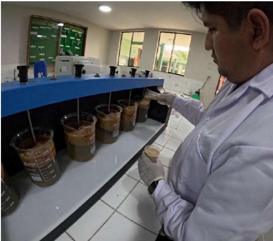
Figura 6 Movimiento de los tratamientos en equipo prueba de jarras
