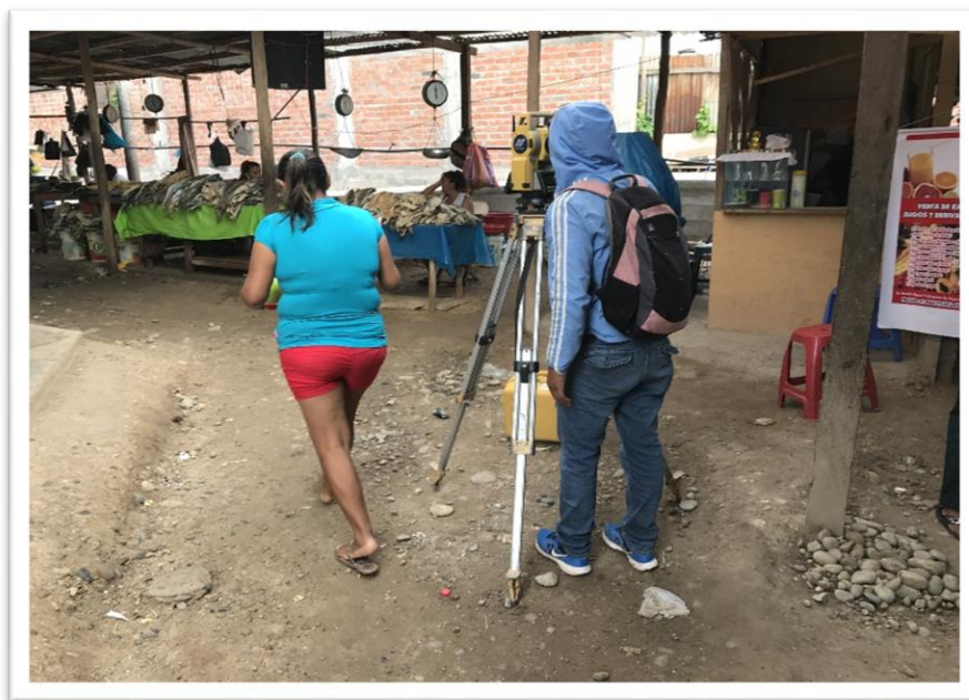
Figura 10: Levantamiento Topográfico con Estación Total en Calle N° 04
