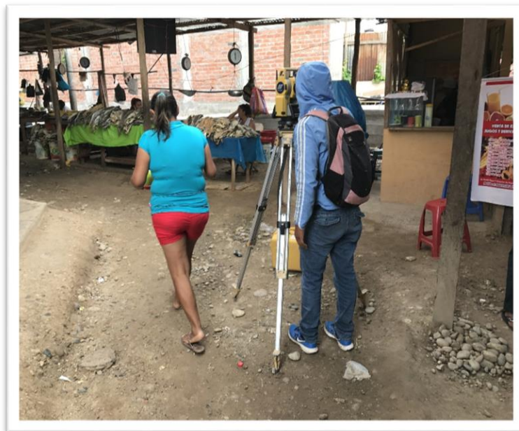
VISTA N°03: Se aprecia el Levantamiento Topográfico con Estación Total en Calle N° 04.
