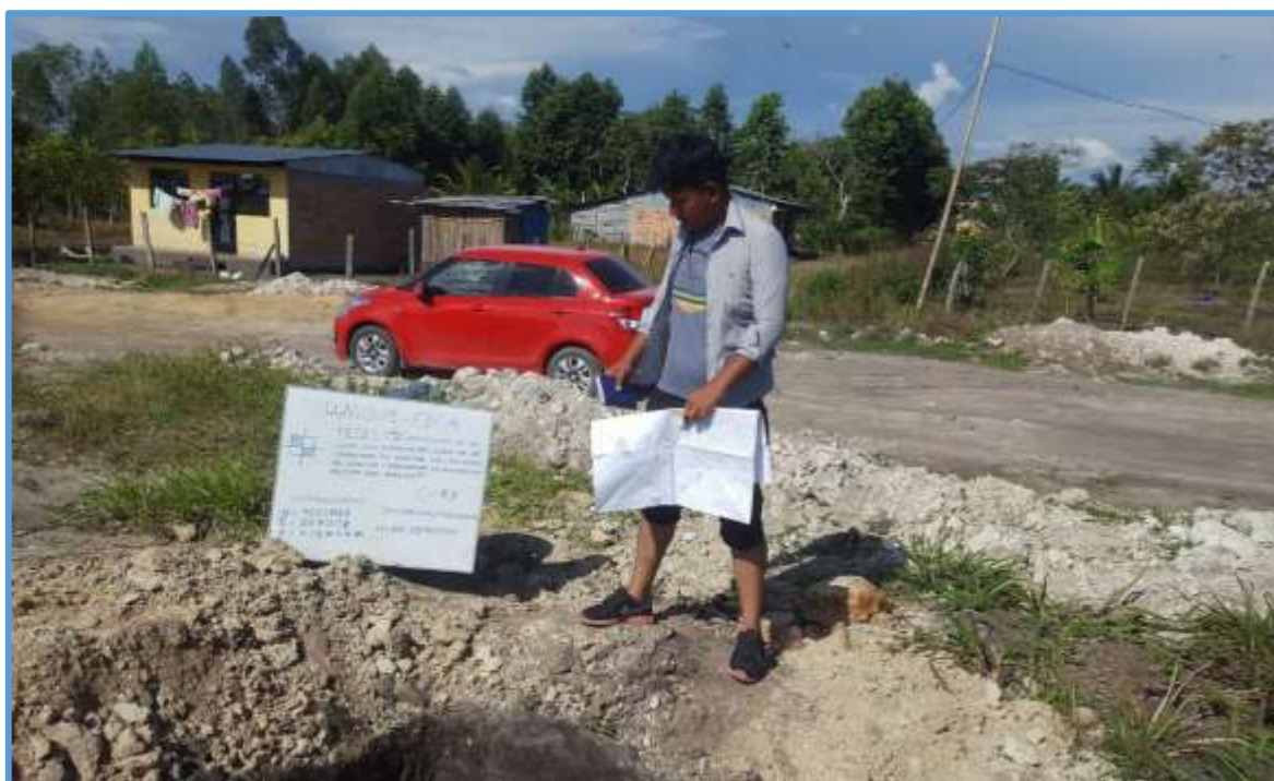
Foto 21: Véase en la imagen la excavación de la décima calicata (C-12) en el Jr. Ochame y Jr. Prolongación Las Flores; N: 9320877, E:268608, A: 906 m.s.n.m.
