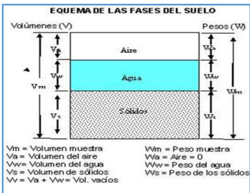
Figura 2: Esquema de una muestra de suelo, en tres fases o húmedo, con la indicación de los símbolos usados: en los costados, v volumen y w peso. las letras subíndice y del centro, son: a aire, w agua y s sólidos
