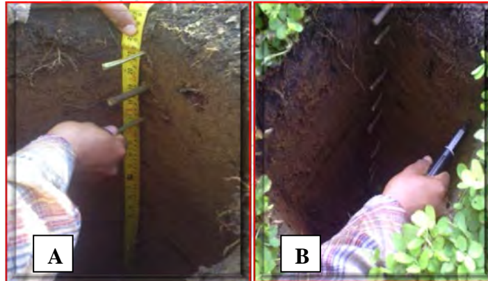
Imagen 05. A. Niveles de profundidad; B Medición con el pocket.
