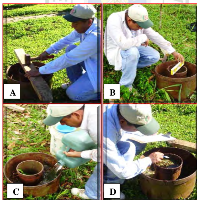
Imagen 02. A. Introducción del cilindro; B Nivelación; C Añadiendo agua; D Realizando la evaluación.
