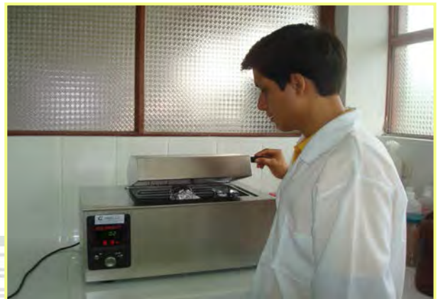
Foto 35: HIDRÓLISIS en ácido clorhídrico (HCL) 1N, en baño maría a 60°C por 8 o 12 minutos.
