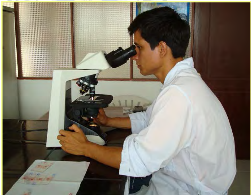
Foto 57: Observaciones microscópicas utilizando inicialmente un aumento de 10X x 10X, luego un aumento mayor de 10X x 40X y finalmente con el aumento de 10X x 100X
