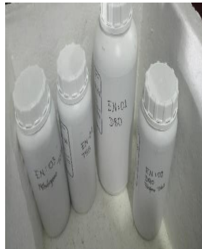
Foto 09: Proceso de toma de muestras, rotulado y acondicionamiento en caja couller para ser enviada a laboratorio.
