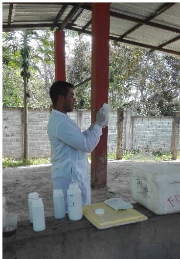
Foto 09: Proceso de toma de muestras, rotulado y acondicionamiento en caja couller para ser enviada a laboratorio.
