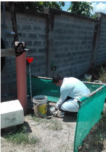
Foto 09: Proceso de toma de muestras, rotulado y acondicionamiento en caja couller para ser enviada a laboratorio.
