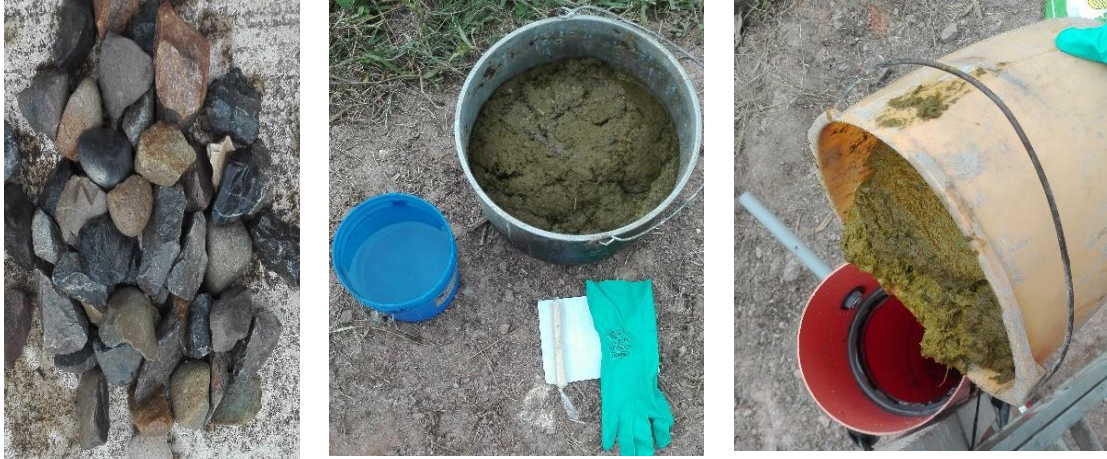
Foto 06: Materiales empleados para dar el inicio del arranque del UASB, grava de 1" de diámetro se instaló en la parte inferior luego se preparó el inóculo a base de rumen y agua residual y se procedió a cargar el UASB.
