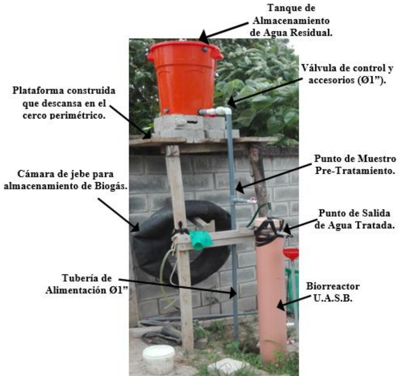
Foto 5: Se observa la vista final de la construcción de la planta piloto, con los componentes necesarios como son el UASB, el tanque elevado de almacenamiento y la cámara para el almacenamiento del Biogás.
