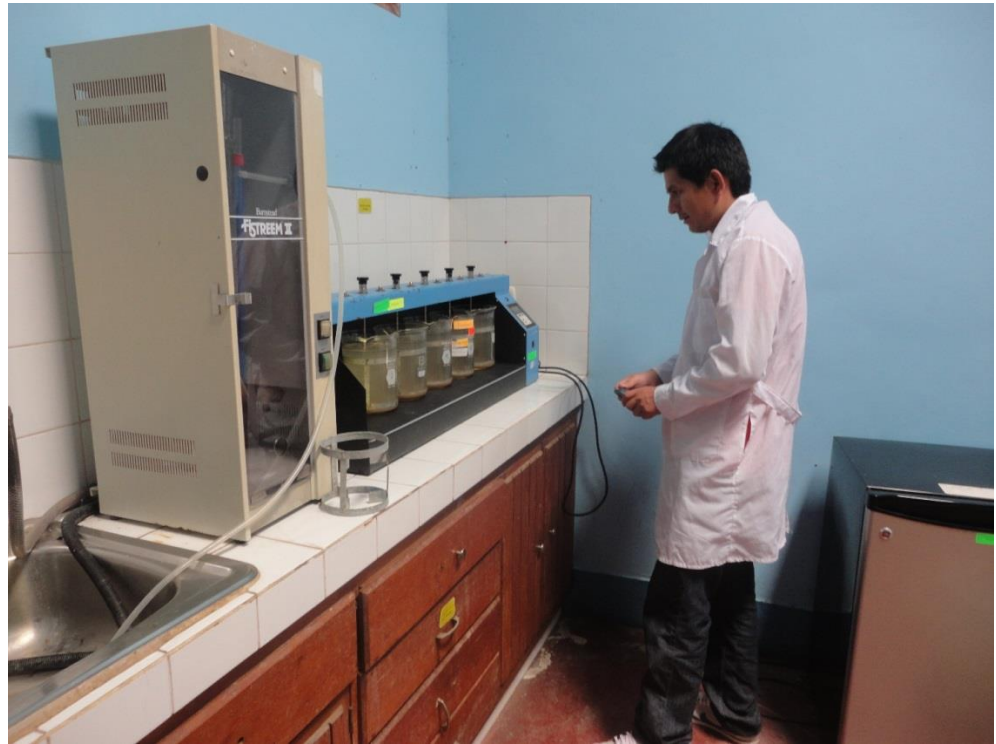
Imagen 05: Determinación de dosis óptima para la adición de coagulante mediante la prueba de jarras.
