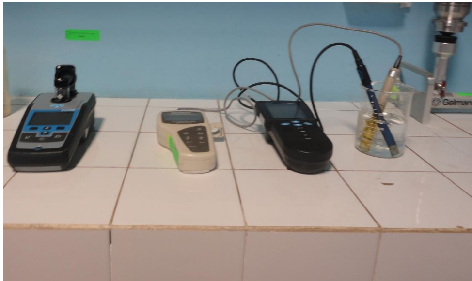
Imagen 03: Equipos empleados para determinar los parámetros de pH y turbidez.
