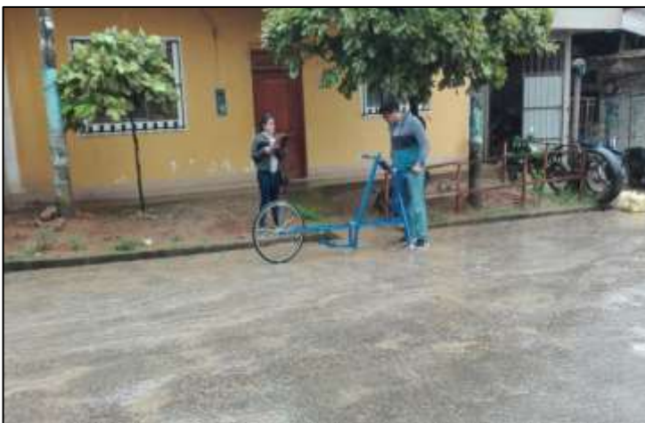
Figura 107. Ensayo de rugosidad en Cuadra 6.
