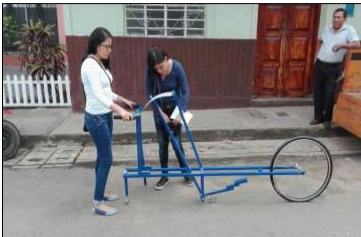
Figura 107. Ensayo de rugosidad en Cuadra 6.
