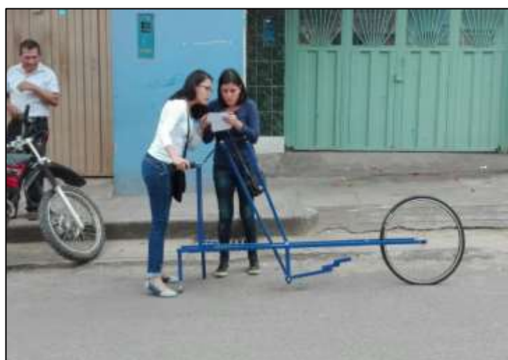
Figura 105. Ensayo de rugosidad en Cuadra 10.
