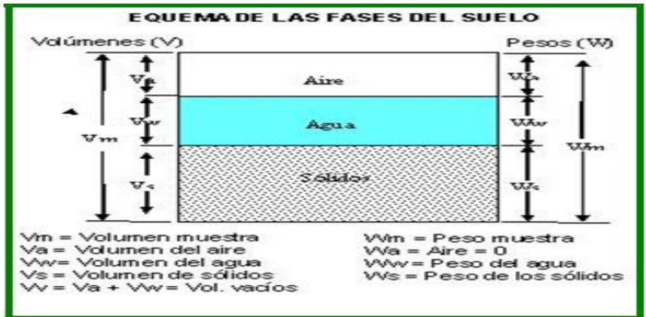
Fig 1: Esquema de una muestra de suelo, en tres fases o húmedo, con la indicación de los símbolos usados: En los costados, V volumen y W peso. Las letras subíndice y del centro, son: A aire, W agua y S sólidos
