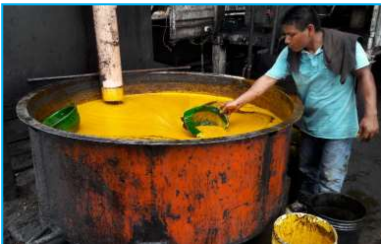
Fotografía 1. Trabajador sin EPPs y utilizando de manera inadecuada un casco de seguridad.
