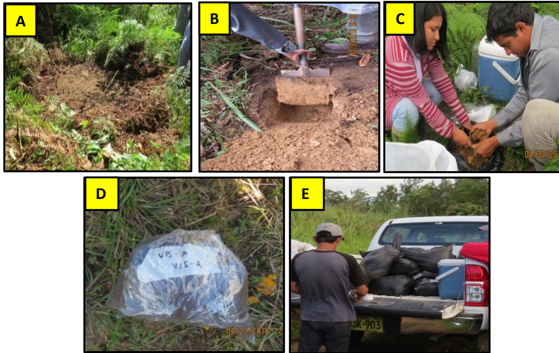
Figura.3. Procedimiento de colecta de suelo: A) Limpieza de la superficie del suelo. B) Colecta de muestras de suelo. C) Homogenización de las muestras. D) Muestra de suelos para análisis microbiológicos y físico-químicos. E) Transporte de muestras de suelo al laboratorio y para la siembra de leguminosas.
