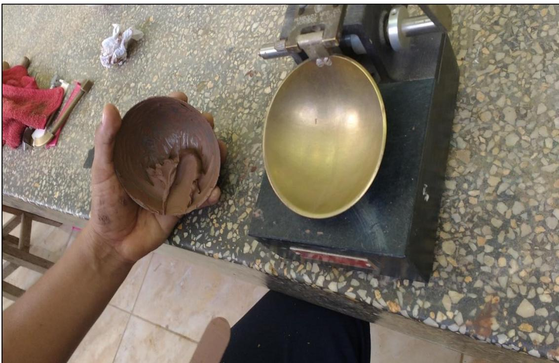
*Foto N° 41:* Se preparó la muestra de suelo húmedo mezclándolo hasta obtener la consistencia adecuada.
