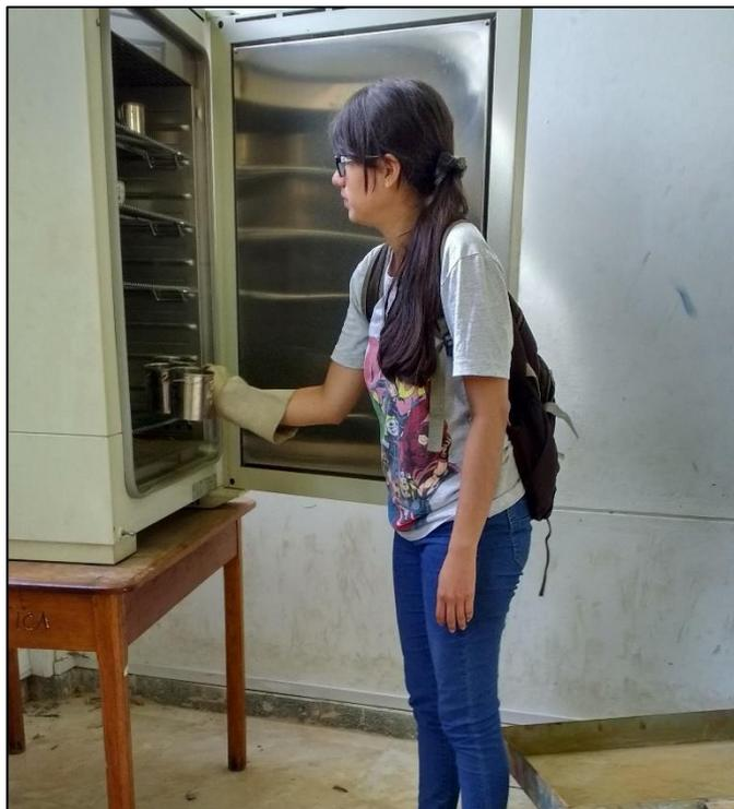
*Foto N° 35:* Se removieron los contenedores del horno pasando las 24 horas indicadas.
