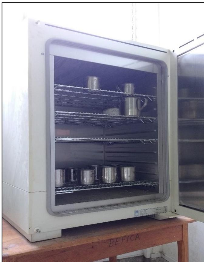
*Foto N° 34:* Se colocaron las muestras con los contenedores en el horno a unos  $110 \pm 5$  °C durante 24 horas.
