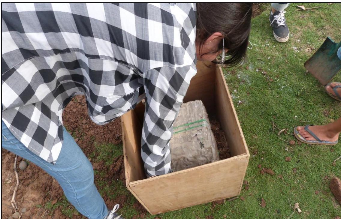
*Foto N° 10:* Se colocó la muestra en una caja de madera con restos de madera (viruta) y aserrín para su amortiguación.
