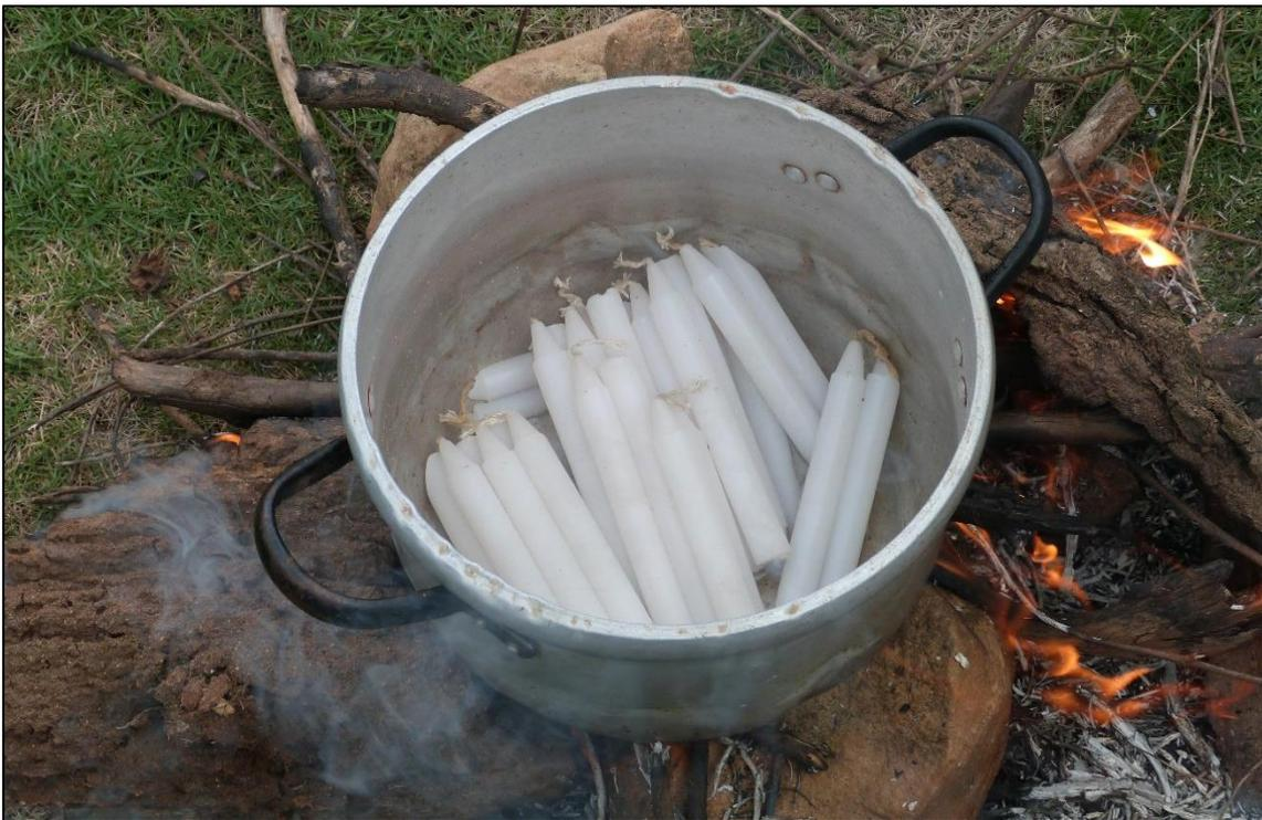
*Foto N° 04:* Se derritió la parafina para cubrir la muestra inalterada.
