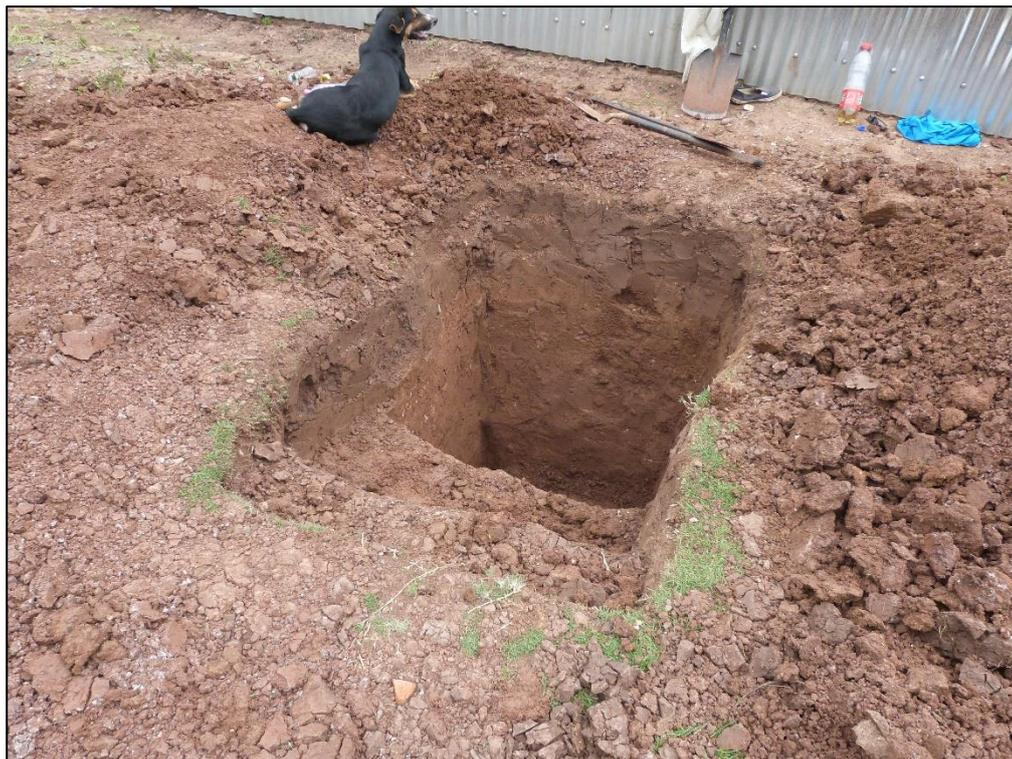
*Foto N° 17:* Vista de la C – 05, se puede observar en la estratigrafía del terreno la existencia de suelos arcillosos.
