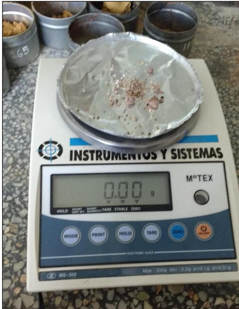
Foto N° 57: Ya tamizada la muestra, se separó lo retenido en cada tamiz y se pesó.
