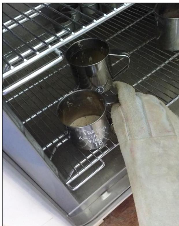
*Foto N° 54:* Se recogió lo retenido en los recipientes para colocarlos en el horno durante 24 horas.
