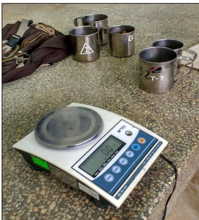
*Foto N° 36:* Luego de dejar enfriar los contenedores, se pesaron las muestras secas con la misma balanza y se registraron los datos obtenidos.
