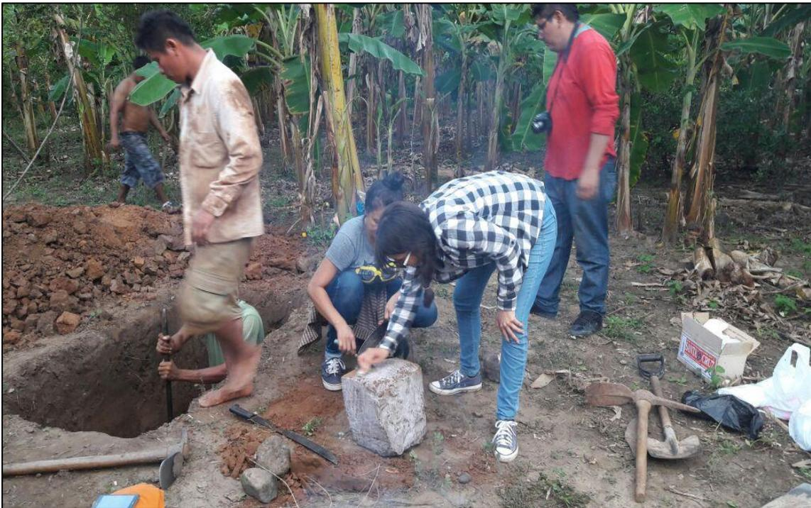
Foto N° 06: Se observa la muestra totalmente cubierta de parafina.
