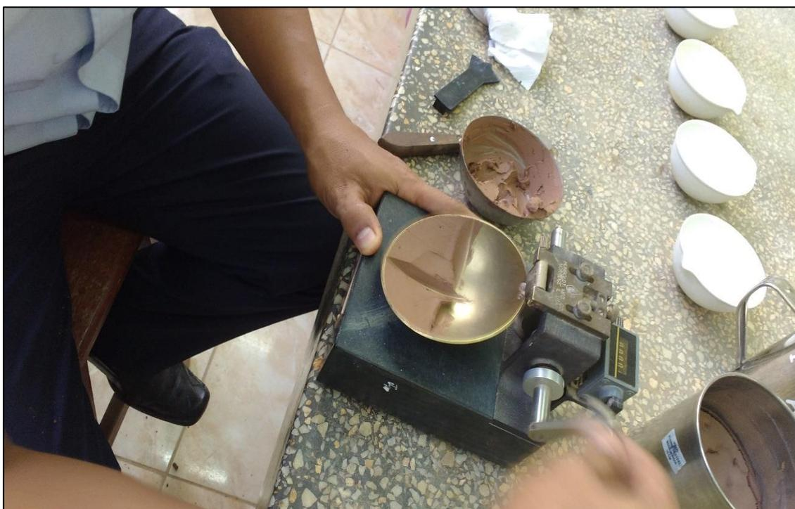
Foto N° 44: Se giró la manivela de la cuchara de Casagrande hasta que las dos porciones de suelo entraron en contacto en la parte inferior de la ranura y se registró el número de golpes realizados.
