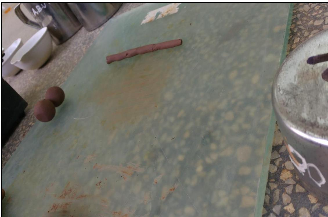
Foto N° 48: Se moldeó la muestra en forma de elipsoide para formar cilindros.
