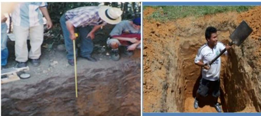
*Figura 23:* Pozos o calicatas a cielo abierto. (Fuente: Martinez, E. Guía de Mecánica de Suelos I, 2014)
