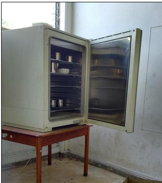
*Foto N° 46:* Se colocaron los recipientes con las muestras en el horno para dejar secar durante 24 horas para pesar las muestras secas.
