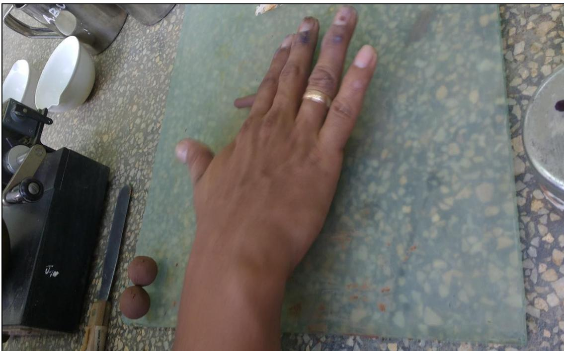
Foto N° 49: Se rodó con las manos sobre una superficie lisa hasta el desmoronamiento de la muestra.
