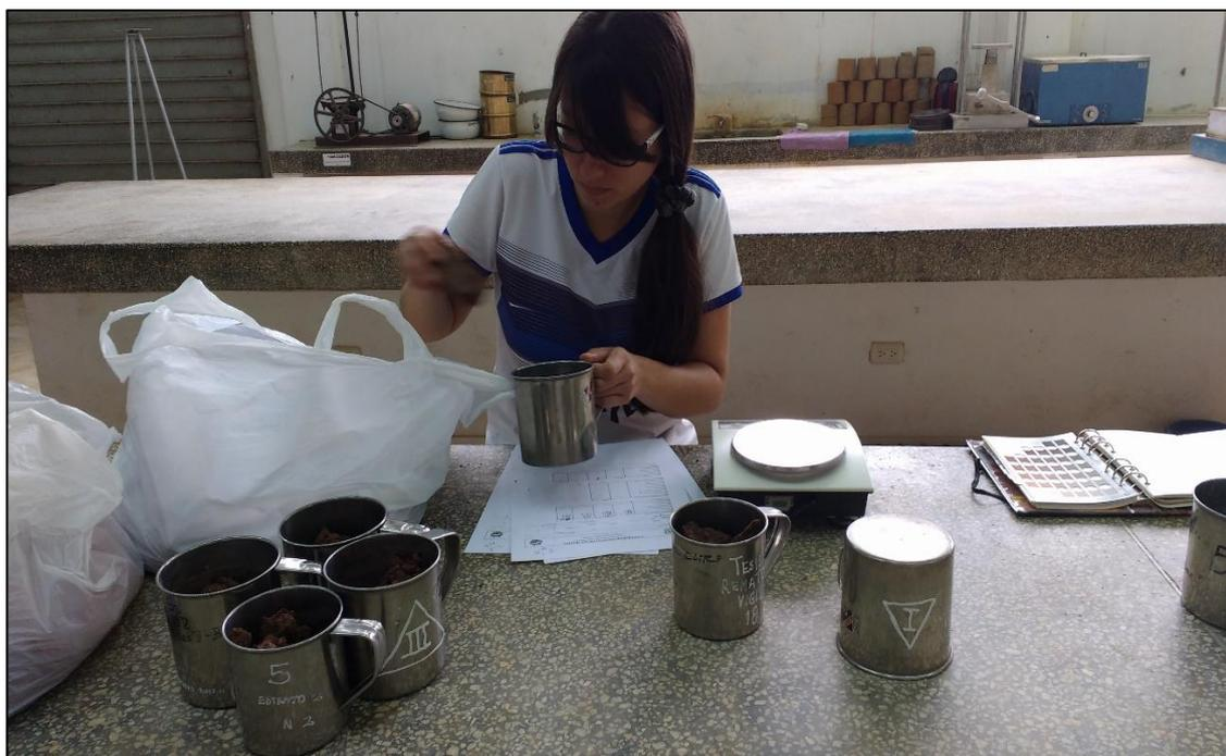
*Foto N° 33:* Se pesaron las muestras húmedas con el contenedor usando una balanza y se registraron los datos.
