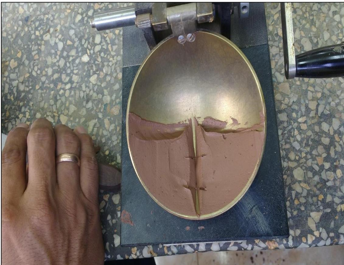
Foto N° 43: Se forma una ranura en la muestra de suelo con ayuda de un ranurador.
