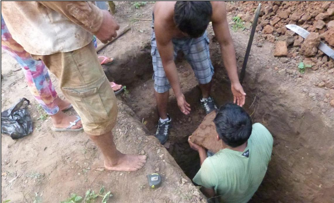
*Foto N° 03:* Se extrajeron dos muestras inalteradas de 30 cm x 30 cm x 30 cm de la calicata para su posterior estudio en el ensayo triaxial.
