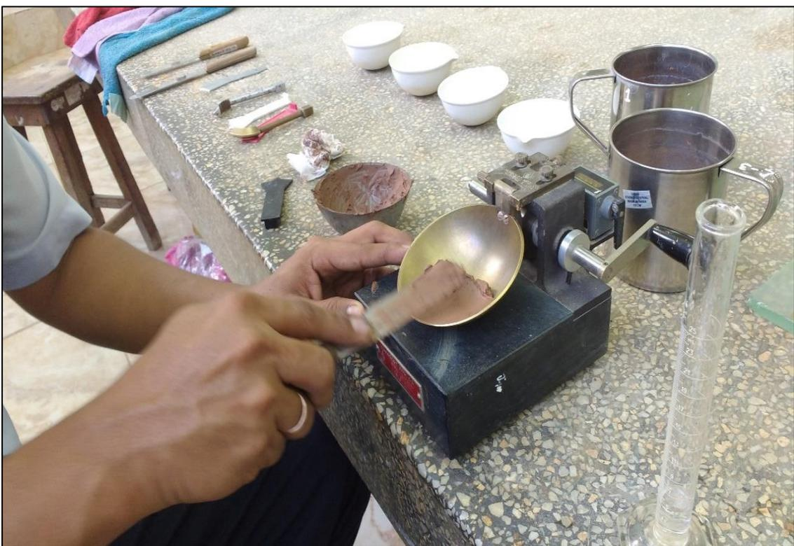
*Foto N° 42:* Se esparció la muestra con ayuda de una espátula dentro de la cuchara Casagrande con una profundidad de 1 cm aproximadamente.
