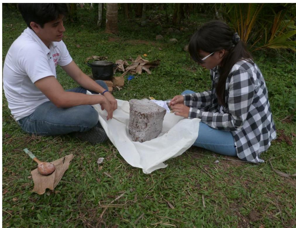
*Foto N° 20:* Se observa la muestra de la C – 09 cubierta de parafina.
