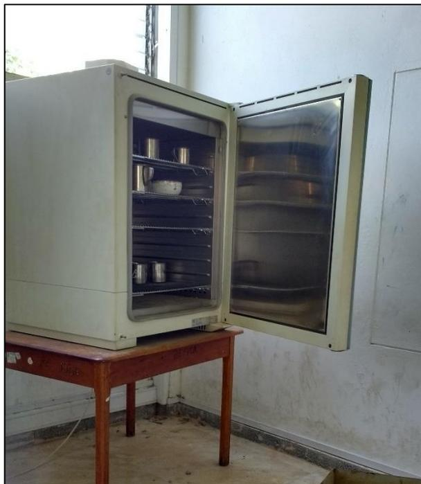
*Foto N° 51:* Se colocaron los recipientes con las muestras en el horno para dejar secar durante 24 horas para pesar las muestras secas.
