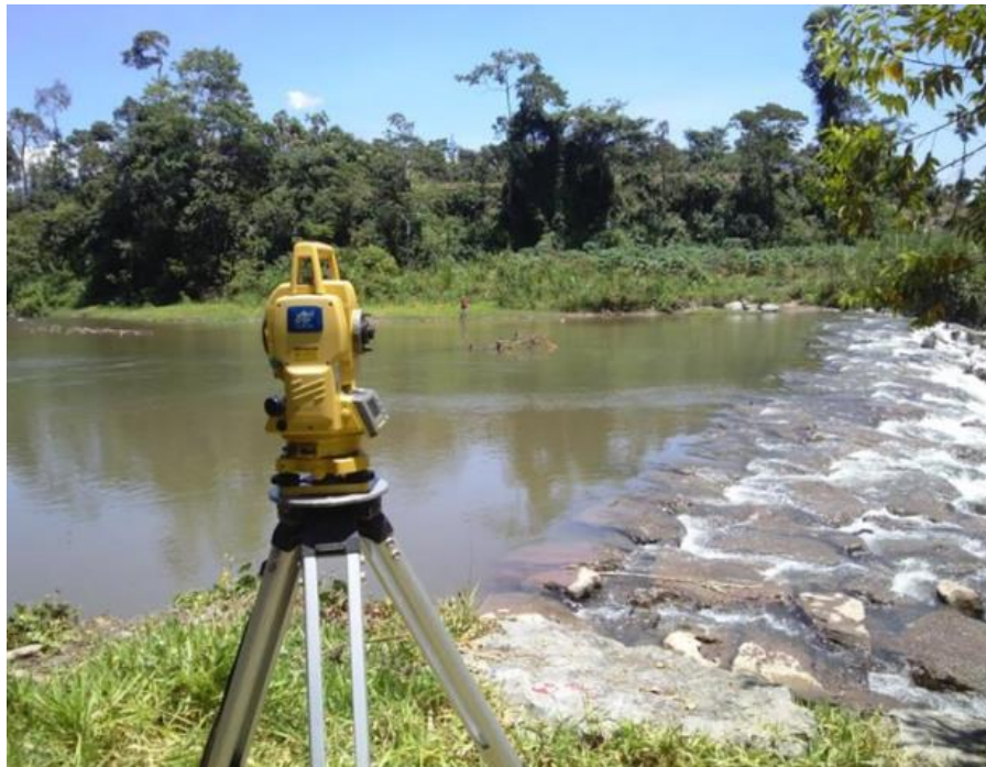
Figura 12. Levantamiento topográfico con estación total (Fuente: Levantamiento topográfico con estación total)
