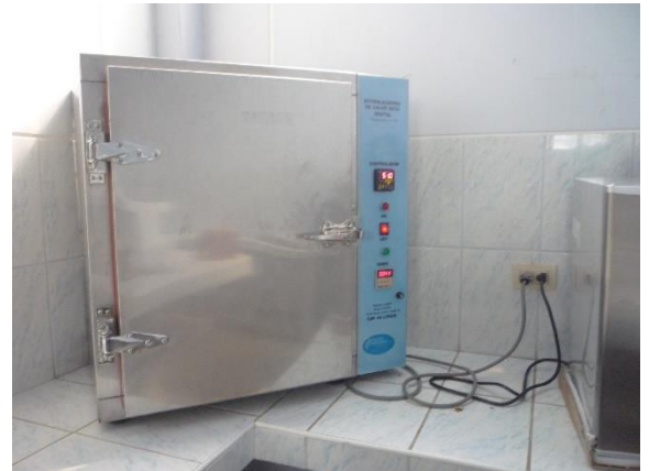
Estufa del laboratorio de investigación a 35°C
