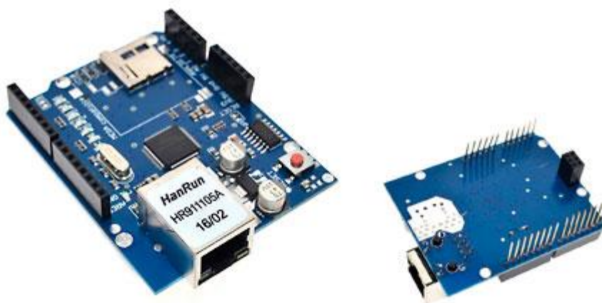
Figura 32: Shield Ethernet W5100 (Fuente: Llamas, 2017)
