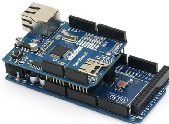
Figura 33: Esquema de montaje Shield Ethernet y Arduino Mega (Fuente: Llamas, 2017)
