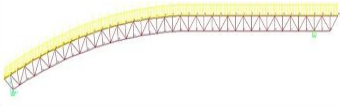
Figura 27: Estado carga de viento “Barlovento” (Piscina)
