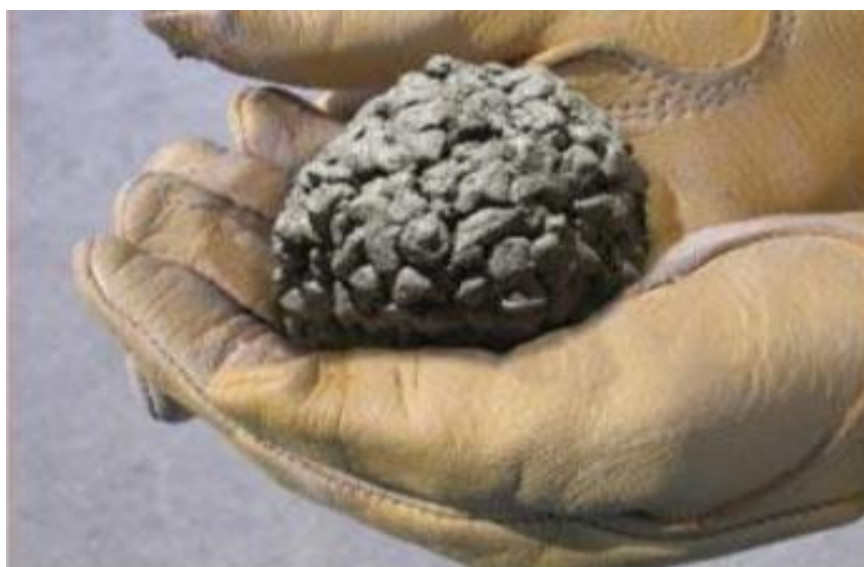
Figura 5. Concreto con agua adecuada (Fuente: Pervious Concrete Pavements )
