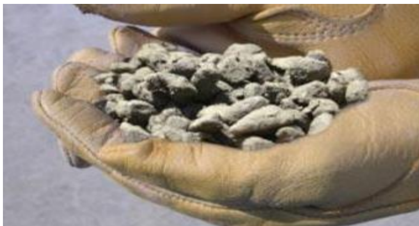
Figura 4. Concreto con muy poca agua (Fuente: Pervious Concrete Pavements.)
