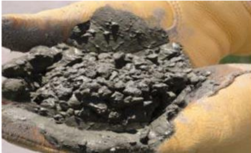
Figura 6. Concreto con mucha agua (Fuente: Pervious Concrete Pavements)
