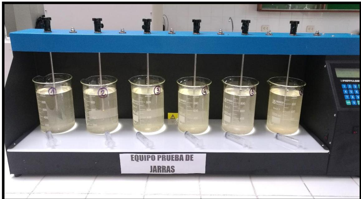
**Fotografía 6: Formación de flóculos (proceso de floculación).**
