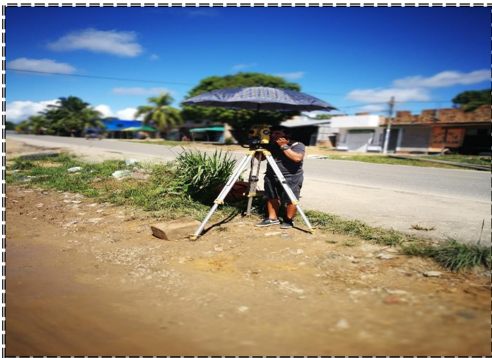
Fotografía 9: Recopilación de datos en campo mediante levantamiento topográfico. Estudio básico para el diseño del abastecimiento de agua potable en la Localidad.
