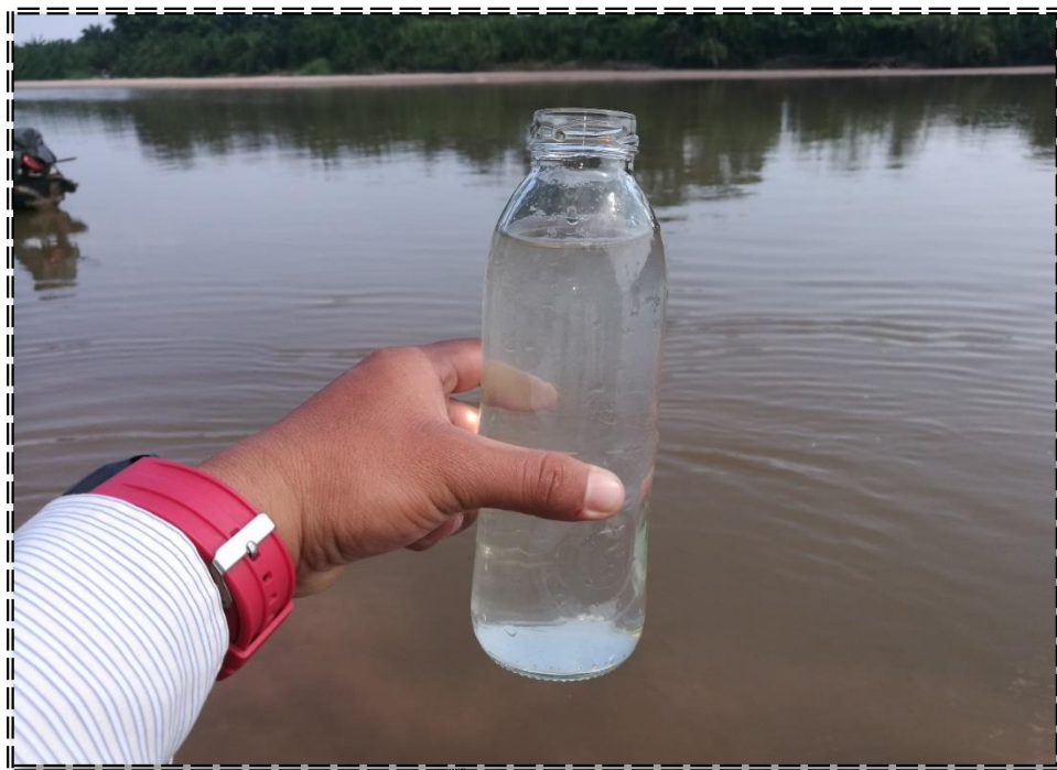
Fotografía 11: Muestra del agua para posterior traslado de acuerdo a lo indicado por el laboratorio para posterior estudio clave para determinar las estructuras del PTAP.
