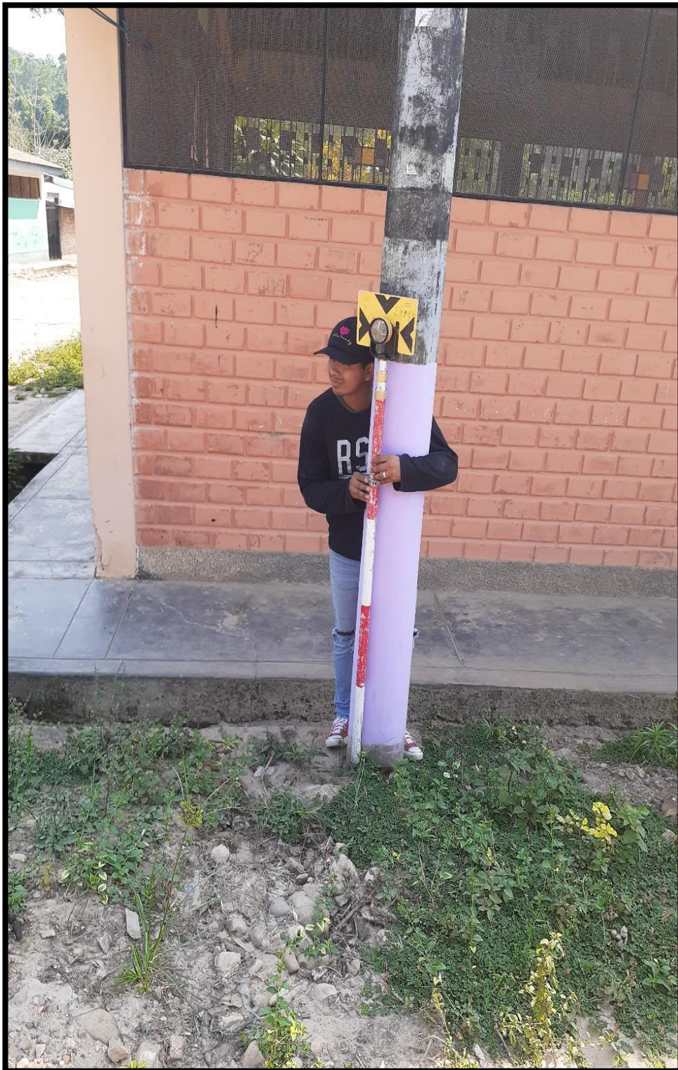
Figura 5. Levantamiento topográfico realizado con estación total, identificando los postes de luz en el Jirón Leoncio Prado.
