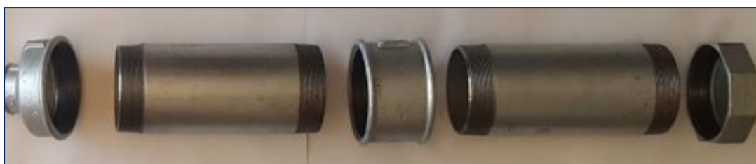
Figura 22. Cámara de aire. (Fuente: Elaboración propia).
