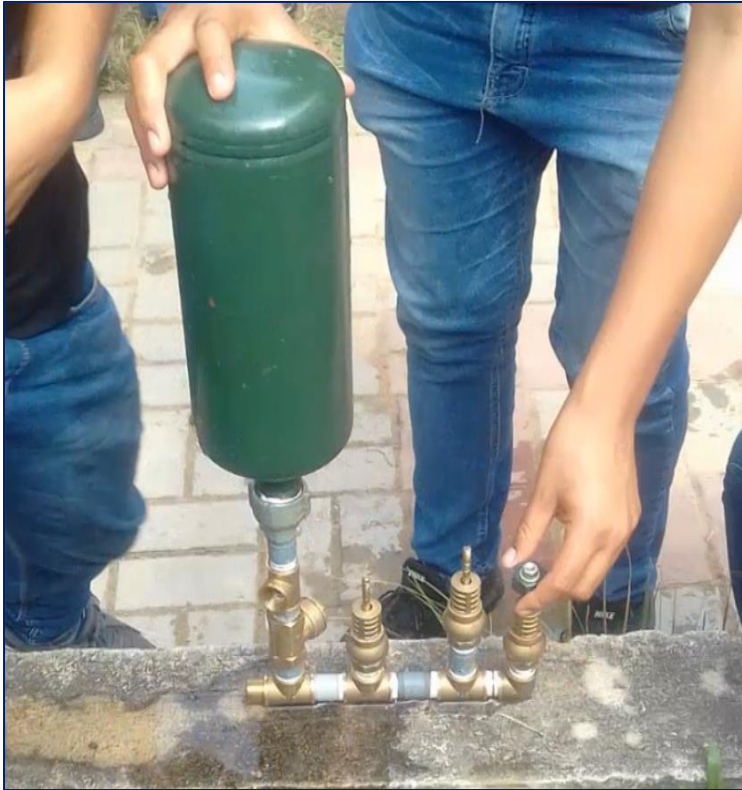
Figura 11. Construcción de la bomba de ariete I. (Fuente: Elaboración propia).
