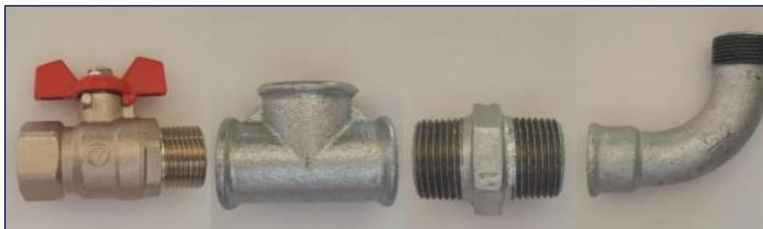
Figura 18. Cuerpo de ariete hidráulico. (Fuente: Elaboración propia).
