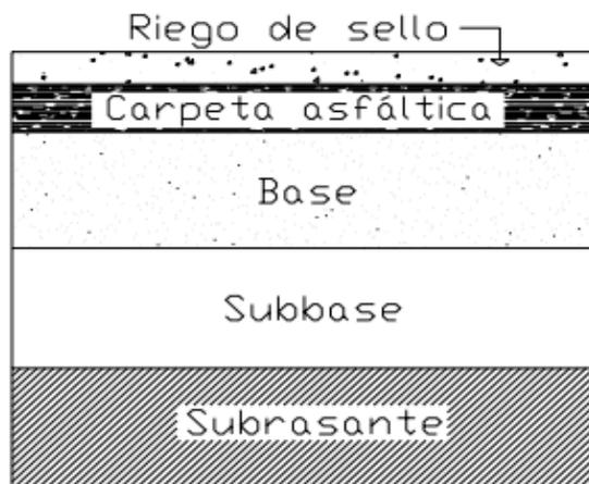
**Figura 4.** Pavimento Flexible. (Fuente: Manual para el diseño de carreteras no pavimentadas de bajo volumen de tránsito).
