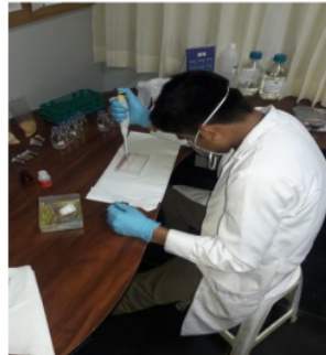
Anexo 22. Adición 100 ul de sustrato cromógeno (etiqueta verde) a todos los pozos blancos, agitar por deslizamientos. Limpiar las bases de los pozos.
